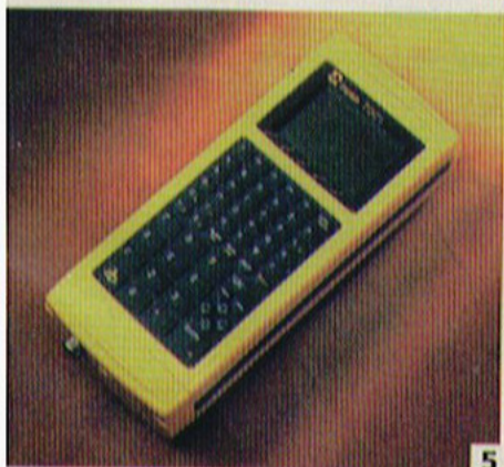
Foto 5 - Registratore di dati Trimble TDC1 (fonte: Trimble Navigation Europe Limited). Foto 6 - Modulo opzionale Trimble Pro XRS «Beacon/Satellite» con relativa antenna (fonte: Trimble Navigation Europe Limited). Foto 7 - Ricevitore Base Leica MX 9400R DGPS Reference Station, presente nei sistemi DGPS March Surveyor e HP-GPS-L4 della CMT (fonte: Leica GPS)
