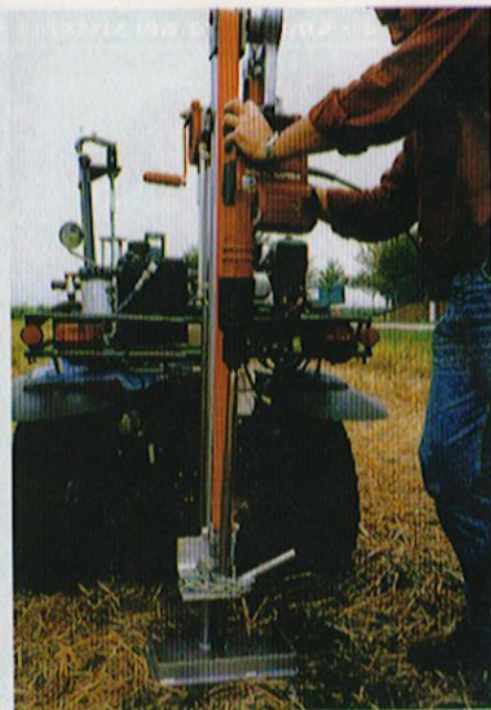
Foto 3 - Il motoveicolo a tre ruote (ATV), dotato del sistema di posizionamento della «SatCon», nonché di una sonda di campionamento, consente all'operatore di prelevare rapidamente i vari campioni di terreno in modo da correlare successivamente i risultati delle analisi chimico-fisiche con i corrispondenti dati di posizione
