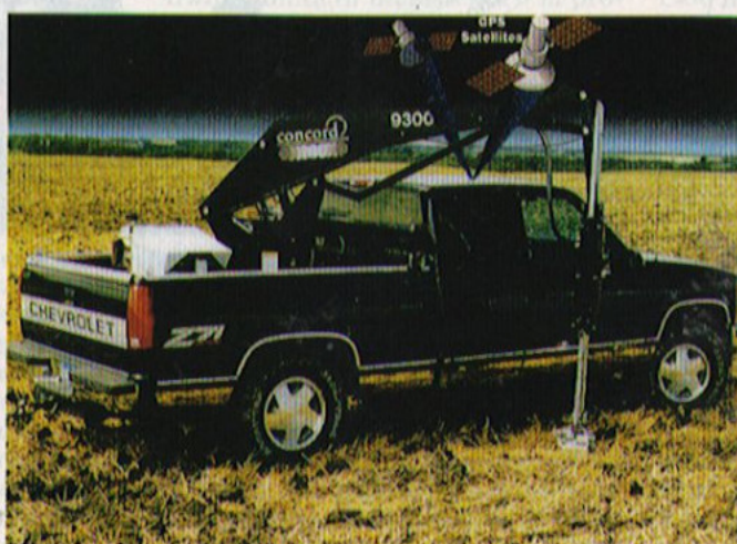
Foto 1 - Per l'attuazione del campionamento spazialmente selettivo dei terreni, una piattaforma completa abbinata al sistema DGPS è rappresentata dal sistema di collezione «multi-zona», la cui sonda (nella foto è mostrato il modello 9300) consente il prelievo contemporaneo di una, due o tre diverse zone di terreno; il tutto in un tempo inferiore al minuto. (Fonte: Concord Environmental Equipment)
