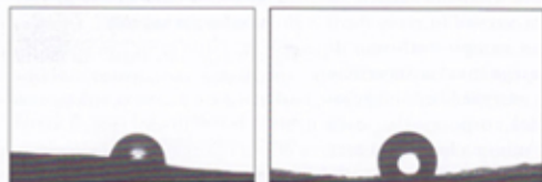
Fig. 20 - Immagine di campione non trattato, a sinistra, e trattato, a destra, per la misurazione dell'angolo di contatto.
