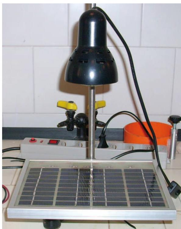
Fig. 8. – Apparato sperimentale costituito da una cella fotovoltaica illuminata con una lampada a incandescenza di 60 W di potenza. La tensione è misurata direttamente con un multimetro digitale.
