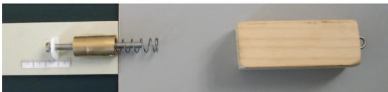
Fig. 1. – Dispositivo a molla per il lancio di oggetti. Il dispositivo realizzato permette di misurare la compressione della molla di costante elastica  $k = 400$  N/m; la massa del blocco è  $m = 78$  g.
