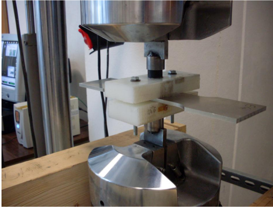
Fig. 4: Applicazione del carico di compressione tramite macchina servoidraulica MTS.
