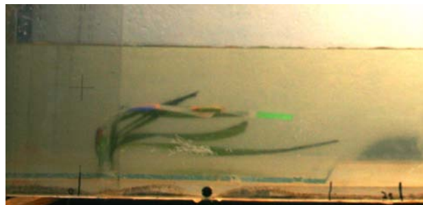
Figura 5. Fase sperimentale in canaletta per sole correnti, confronto tra la pianta vera e la pianta artificiale sottoposte alla stessa corrente.
