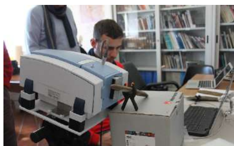
Fig. 2 Indagini su un lingotto condotte in situ mediante spettrometria FT-IR.
