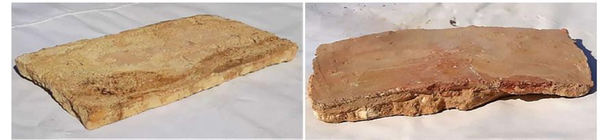
Fig. 2 - Esempi di *parmarizzi* usati per la realizzazione delle volte realine. © 2019, immagini degli autori.
