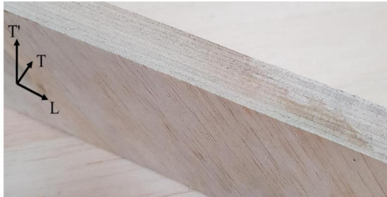
Fig. 2.21 Core innovativo in laminato di balsa opportunamente implementato in questo lavoro con fibre orientate a  $\pm 45^\circ$  rispetto all'asse longitudinale L.
