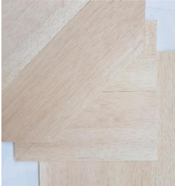
Fig. 2.24 Fogli di balsa ritagliati e orientati per la realizzazione del core con lay-up
