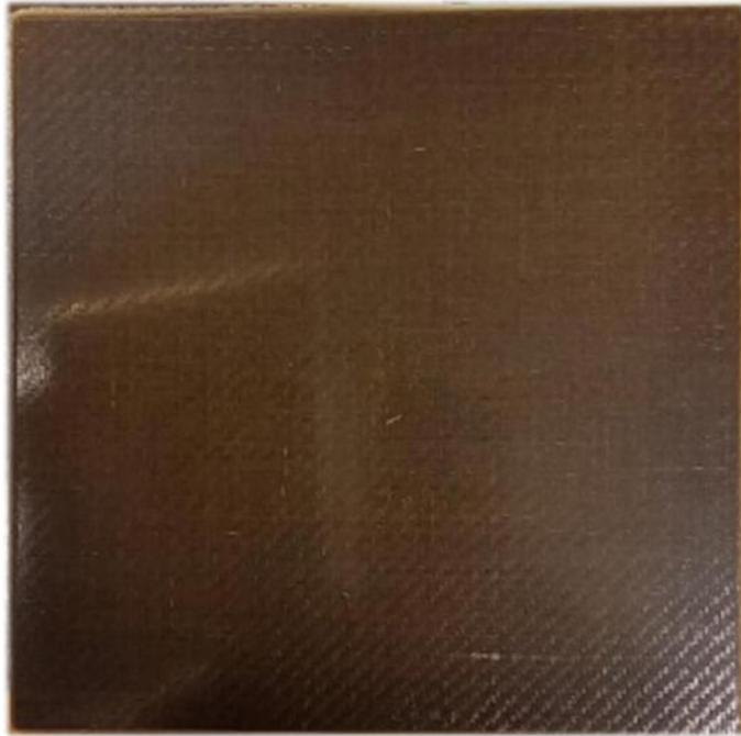
Fig. 2.17 Pannelli di biocomposito in fibre di lino.
