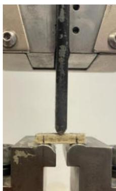
Fig. 5.13 Provino prima della prova di taglio interlaminare ILSS.
