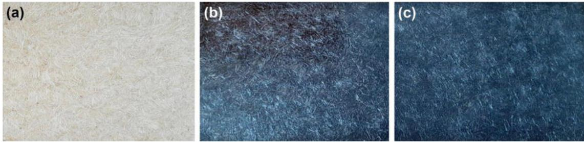
Fig. 2.11 Pannelli di biocomposito: (a) CNT0%, (b) CNT1% e (c) CNT2%.
