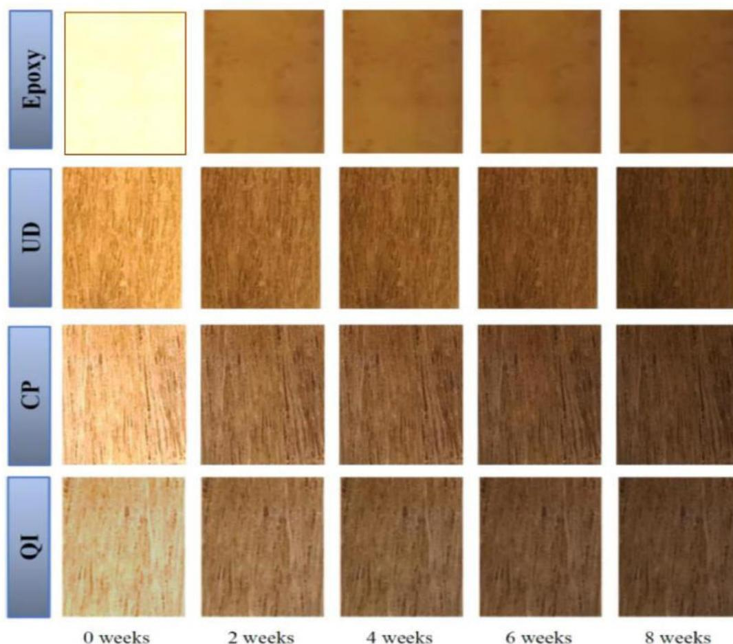
Fig. 4.38 Provini sottoposti a diversi steps di invecchiamento accelerato.
