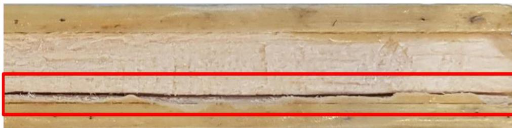
Fig. 6.17 Vista laterale (piano LT') cedimento a taglio del core (scorrimento evidenziato in rosso) del Provino 1.
