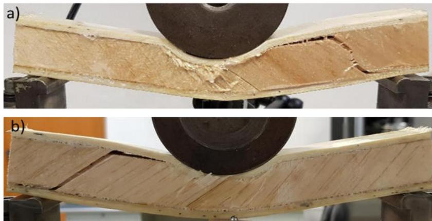
Fig. 6.45 Cedimento del core per taglio: viste a) frontale e b) posteriore.
