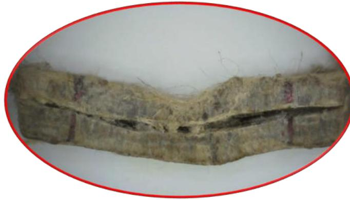
Fig. 5.15 Modalità di rottura dei biocompositi sottoposti a taglio interlaminare.
