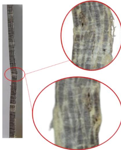
Fig. 5.6 Modalità di rottura dei biocompositi sottoposti a compressione.
