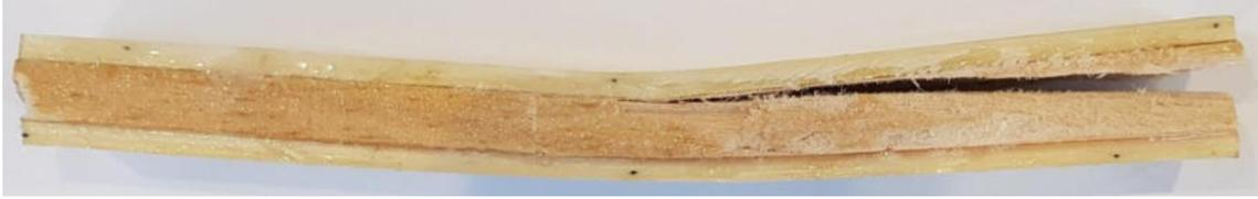
Fig. 6.31 Ingrandimento della linea di frattura causata dal cedimento a taglio del core del Provino UD\_B0<sub>11</sub>.
