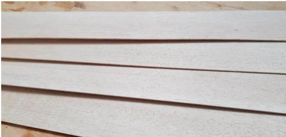
Fig. 2.23 Fogli di balsa utilizzati per la realizzazione dei core.
