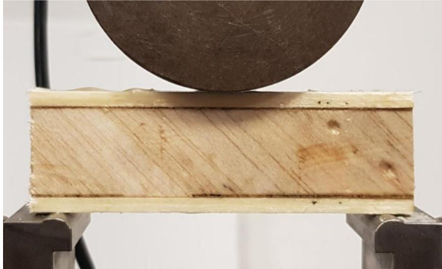
Fig. 6.35 Provino UD\_B45°<sub>25</sub> corto soggetto a flessione per tre punti.
