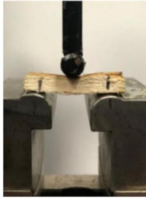
Fig. 4.45 Test di taglio interlaminare ILSS.
