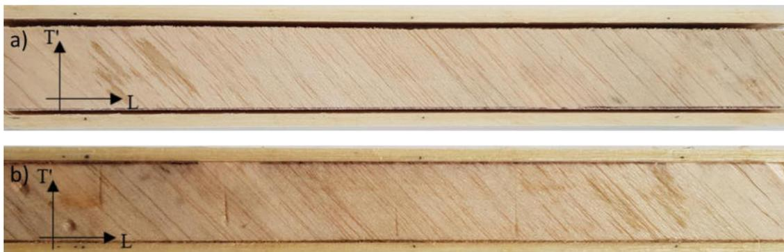
Fig. 2.25 (a) skins e core ritagliati e affiancati e b) sandwich assemblato mediante
