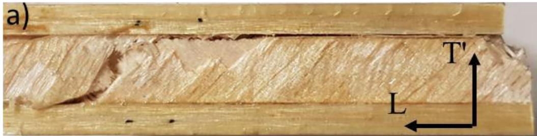
Fig. 6.19 Vista laterale (LT') del cedimento a taglio del provino 1.
