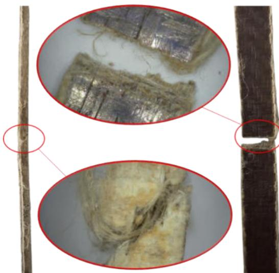
Fig. 5.3 Modalità di rottura dei biocompositi sottoposti a trazione.
