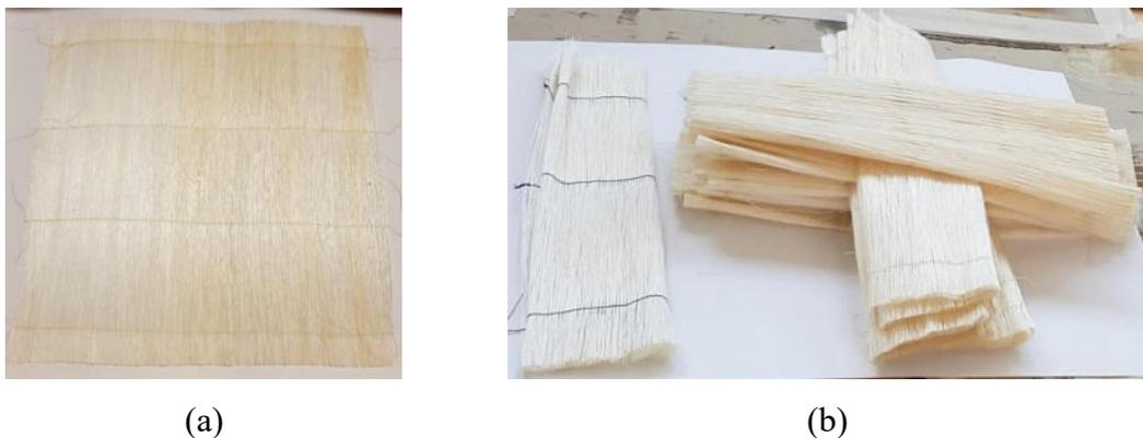
Fig. 1.3 Tessuti di fibre di sisal: (a) tessuto pronto per la successiva laminazione e (b) selezione dei tessuti necessari per la produzione di un pannello in biocomposito.
