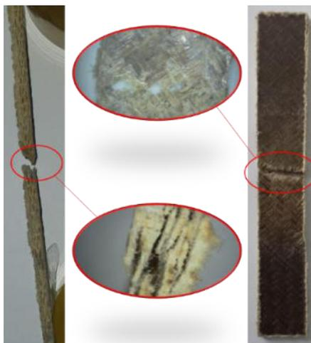
Fig. 5.12 Modalità di rottura dei biocompositi sottoposti a taglio intralaminare con fibre disposte a  $\pm 45^\circ$ .
