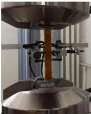
Fig. 4.39 Provino strumentato con estensometro prima del test di trazione.
