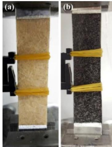
Fig. 7.1 Provini di biocomposito (a) senza nanotubi e (b) con nanotubi di carbonio prima del test di trazione.
