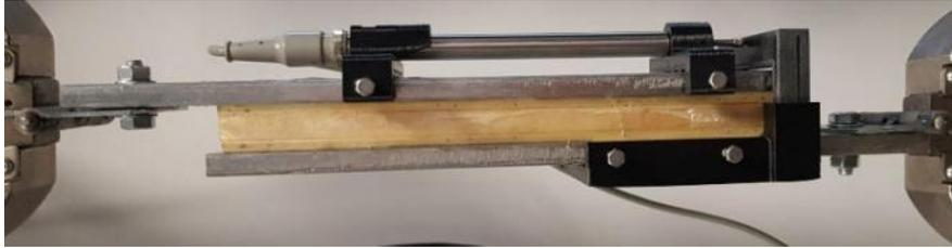
Fig. 6.11 Prove di taglio: provino strumentato e installato sulla macchina di prova materiali.
