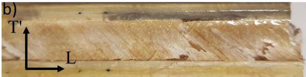
Fig. 6.20 Vista laterale (LT') del cedimento a taglio del provino 2.
