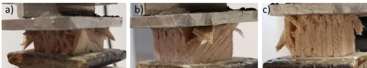
Fig. 6.5 Cedimenti durante l'esecuzione delle prove: (a) Provino da 11.5 mm, (b) Provino da 22 mm e (c) Provino da 25 mm.
