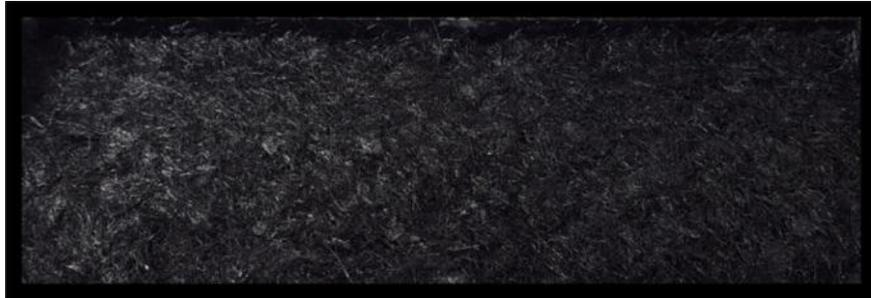
Fig. 2.9 Miscela di fibre corte di sisal e resina epossidica green con nanotubi di carbonio all'interno dello stampo.
