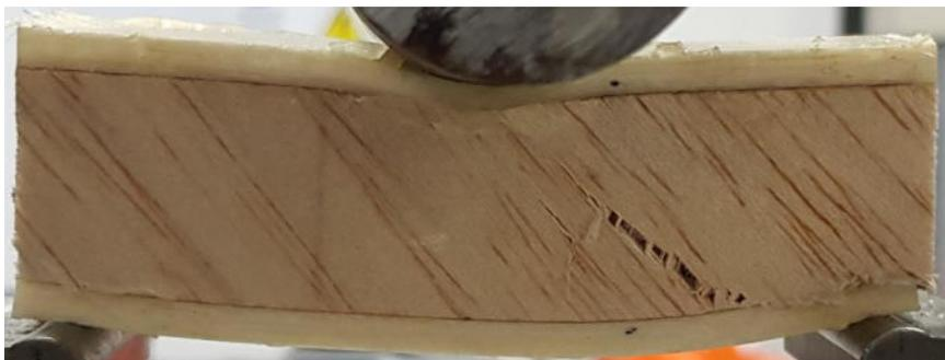
Fig. 6.37 Rottura per cedimento del core del Provino 1 UD\_B45<sub>25</sub> corto.
