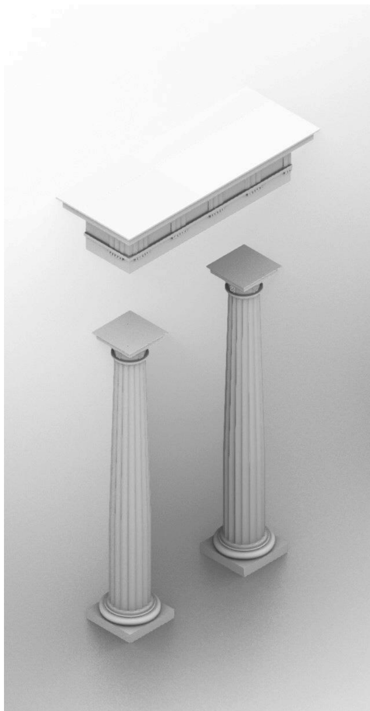
Figura 25: Suddivisione del sistema trilitico (doppia colonna sormontata dalla trabeazione). La seguente operazione di scomposizione è stata eseguita anche per tutti gli altri ordini.
