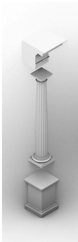
Figura 24: Macro suddivisione dell'ordine architettonico (dal basso: piedistallo, colonna e trabeazione). La seguente operazione di scomposizione è stata eseguita anche per tutti gli altri ordini.
