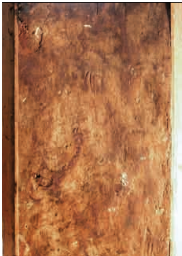
Fig. 7 – Ignoto iconografo, Santi Oliva, Elia, Venera e Rosalia , metà del XIII secolo, Museo Diocesano, Palermo, immagine del verso che mostra gli evidenti segni di lavorazione lasciati sulla superficie dalla pialla e dagli altri strumenti impiegati.
