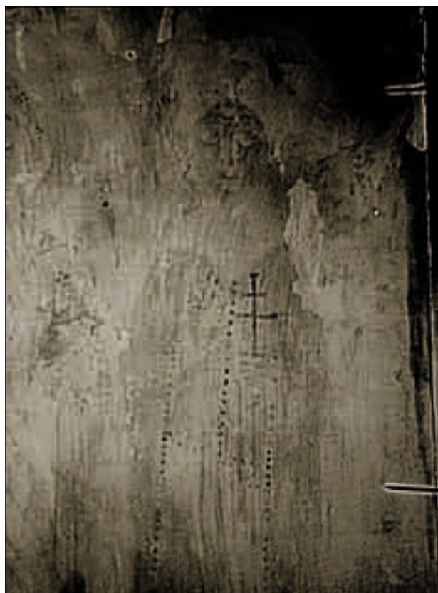
Fig. 24 – Ignoto iconografo, Santi Oliva, Elia, Venera e Rosalia , metà del XIII secolo, Museo Diocesano, Palermo, radiografia che mostra i chiodi metallici impiegati per vincolare i listelli lignei laterali.
