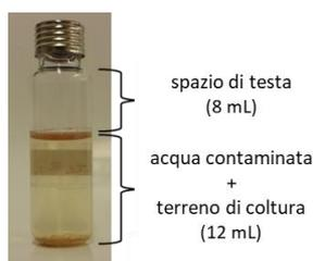
Fig. 2.7 Microcosmo allestito all'interno di vial da 20 mL.
