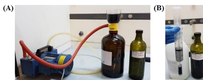
Fig. 1.3 Filtrazione di acqua contaminata (A) su membrana in SFCA con pompa da vuoto e (B) su membrana in PES con sistema Sterivex<sup>™</sup>.
