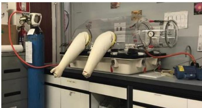
Fig. 2.8 Allestimento di microcosmi anaerobi in glove box con atmosfera saturata con N<sub>2</sub> sterilizzato.
