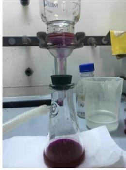
Fig. 2.10 Sistema di filtrazione sotto vuoto utilizzato per recuperare la biomassa dei microcosmi.
