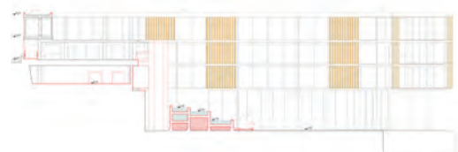
Fig. 4 | Sezione di progetto (sistema di facciata)
