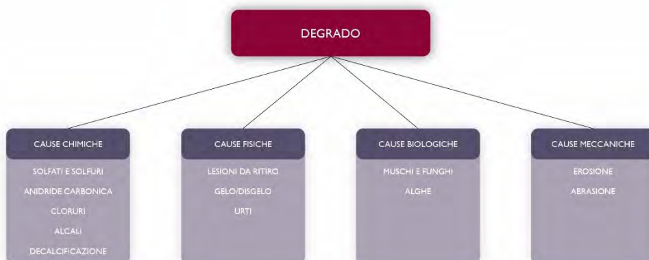
Fig. 61 | Illustrazione schematica delle più comuni cause di degrado (elaborazione dell'A.)
