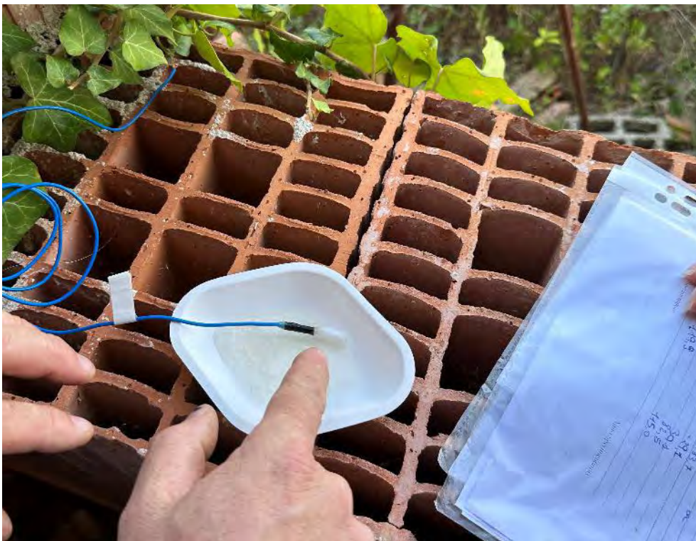
Fig. 119 | Predisposizione elettrodo (F. Anania, settembre 2023)
