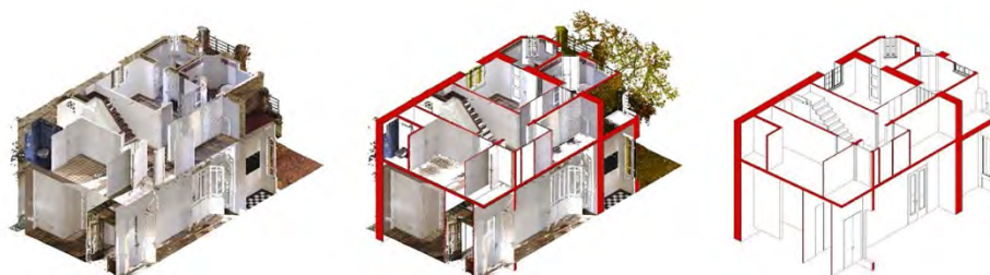
Fig. 69 | Da sinistra: nuvola di punti; sovrapposizione nuvola di punti e modello BIM; modello BIM
