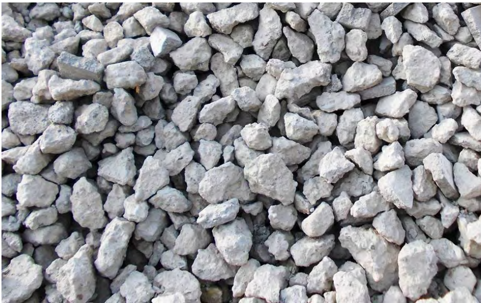
Fig. 72 | Aggregati provenienti da calcestruzzo riciclato (credit: Stroppiana, da Calcagnini et al., 2021)
