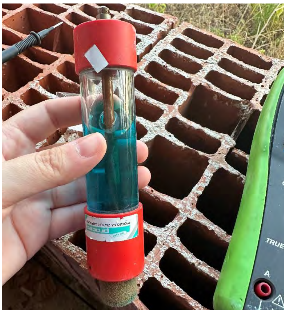
Fig. 127 | Controelettrodo utilizzato per le rilevazioni in situ (credit: F. Anania)
