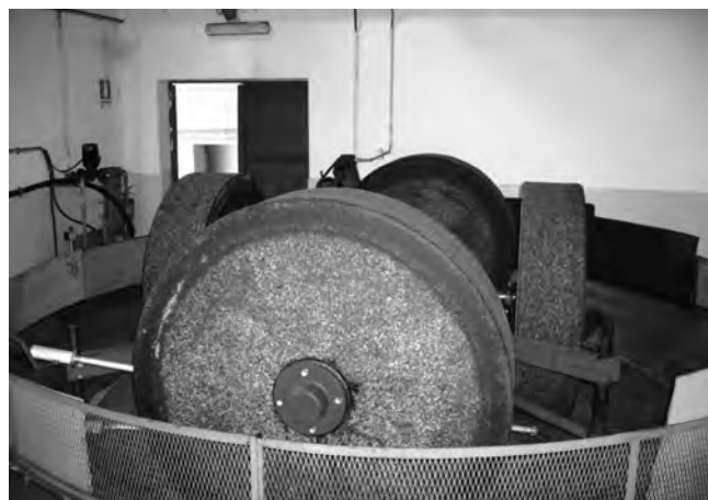
Fig. 4 - Molazza a 4 ruote della Coop. Nuovo Cilento, San Mauro Cilento.
