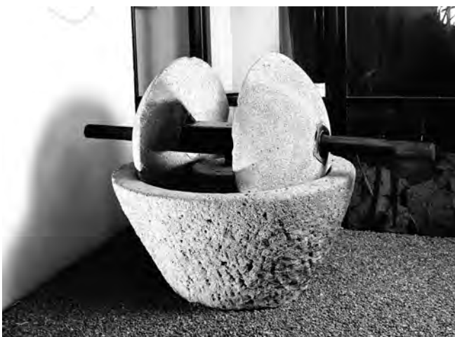
Fig. 2 - Trapeta Boscoreale: macina catoniana (trapezium) integrata nelle sue parti lignee, che consiste in un grosso mortarium in lava vesuviana in cui girano due orbes a calotta sferica mobili e sospese su un'asta in legno (cupa), bloccata in un perno in ferro (columella ferrea) nel mezzo del miliarium. (Per gentile concessione della Soprintendenza Archeologica di Pompei). Fig. 2 - Ancient millston found in Pompei area.
