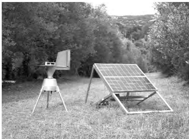
Fig. 1 - Catturatore pollinico (Lanzoni VPPS 2000). Fig. 1 - Pollen sampler (Lanzoni model VPPS 2000).
