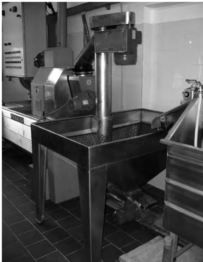
Fig. 5 - Frangitore a martelli dell'Az. Agr. Olivicola Severini, Casal Velino. Fig. 5 - Olive press of Az. Agr. Severini
