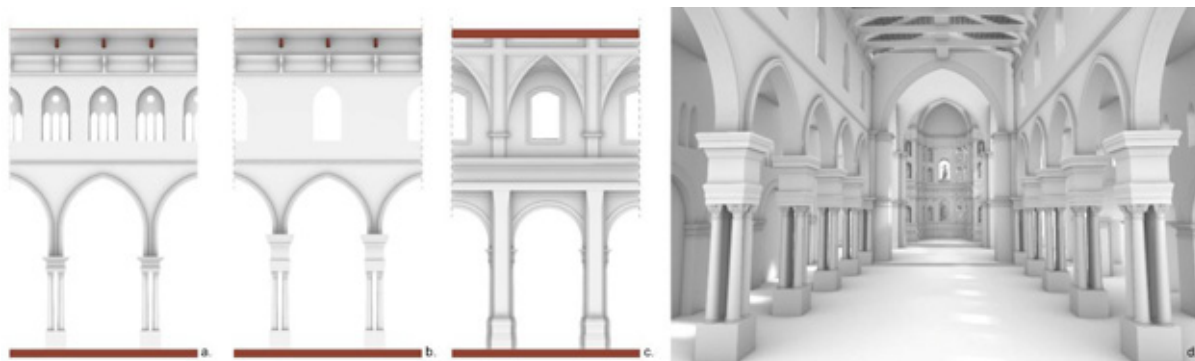
Fig. 2 Da sinistra: a) configurazione della navata centrale alla fine del XVI secolo; b) configurazione della navata centrale alla metà del XVII secolo, dopo gli interventi voluti dall'arcivescovo Martino; c) configurazione attuale della navata centrale, dopo la 'riforma' del XVIII secolo; d) vista prospettica del modello ricostruttivo della Cattedrale nel Seicento (fonte: elaborazione a cura di Maria Isabella Grammauta).
