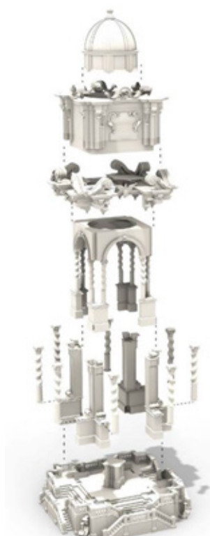
Fig.6 Esploso assonometrico generale dei componenti architettonici del catafalco (fonte: elaborazione a cura di Davide Gianluca Abbate).
