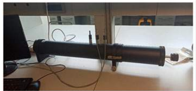
Figura 2. Tubo de impedancias con el porta muestras de 100 mm de diámetro.
