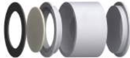
Figura 4. Despiece del primer prototipo sobre el que se ensayarán actuadores y distintos materiales para la placa.
