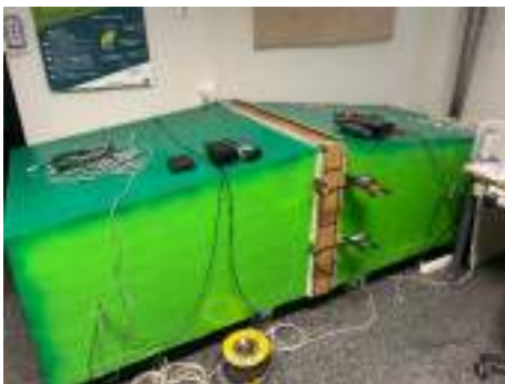
Figura 3. Detalle de ensayo en cámara de transmisión a escala.
