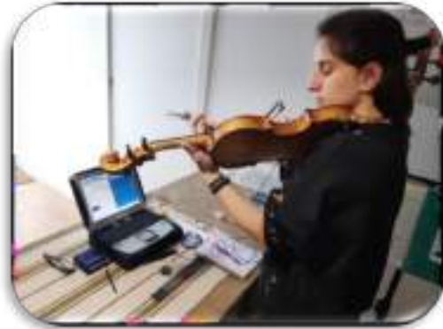
Figura 5. Ensayo de medición de la señal vibratoria de un violín.
