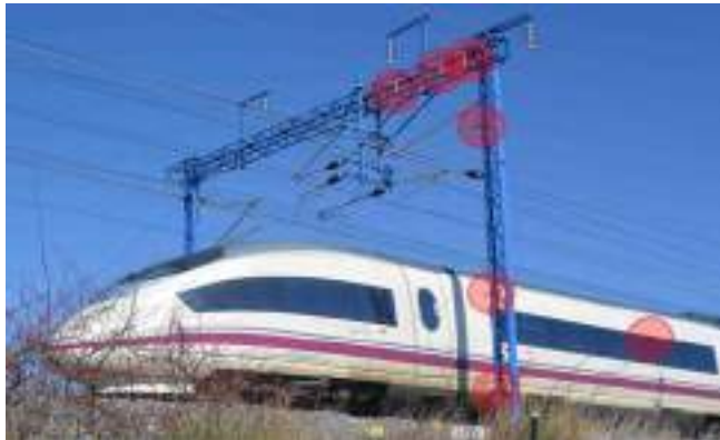
Figura 1. Antecedentes de mediciones en campo cercano de ruido al paso de una unidad de alta velocidad, realizadas en la red de Adif en el marco del proyecto de alta velocidad británico HS2 [2].
