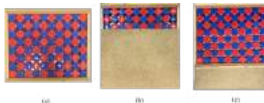
Figura 4. Detalle de algunas configuraciones a estudiar para absorción: (a) Matriz de 10x8 tapones: configuración Plana (P), (b) Matriz con fieltro de cáñamo en parte superior: 0configuración Plana Cáñamo Superior (P-C-S), (c) Matriz con fieltro de cáñamo en parte inferior: configuración Plana Cáñamo Inferior (P-C-I).
