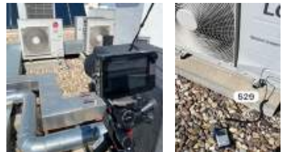
Figura 4. Instrumentación utilizada, cámara de alta velocidad y vibrómetro.
