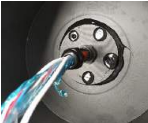
Figura 7. Detalle del acabado hermético de la parte posterior de la caja con el cableado necesario (señal proveniente del amplificador y alimentación del acelerómetro)
