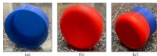
Figura 1. Detalle de algunas configuraciones a ensayar: (a) Configuración simple Hueca (b) Configuración simple Plana, (c) Configuración doble Plana-Plana.
