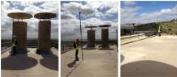
Figura 3. Exemplo de medição de campo próximo de duas chaminés ruidosas (esquerda) e pontos de validação próximos, na direção da área residencial.
