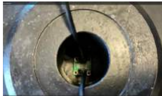
Figura 5. Detalle del acelerómetro una vez pegado en el diafragma por la parte de atrás.
