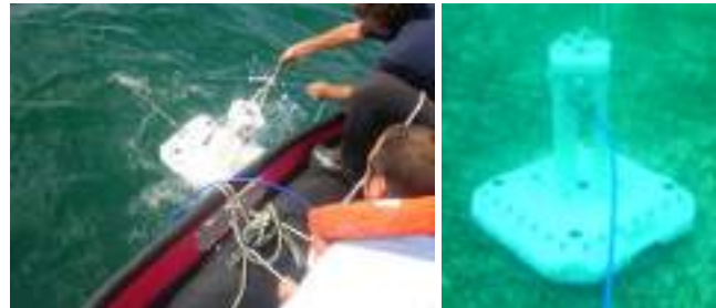
Figura 2. Sensor submarino Multi-Influencia (USU) durante el despliegue (izquierda) y desplegado en el fondo del mar (derecha).
