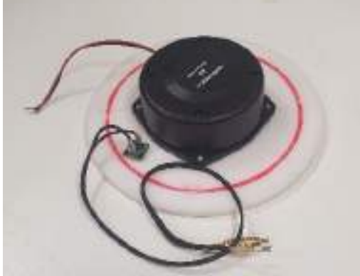
Figura 10. Disposición del actuador en la placa radiante. Situación del acelerómetro para la obtención de la potencia de radiación del altavoz.
