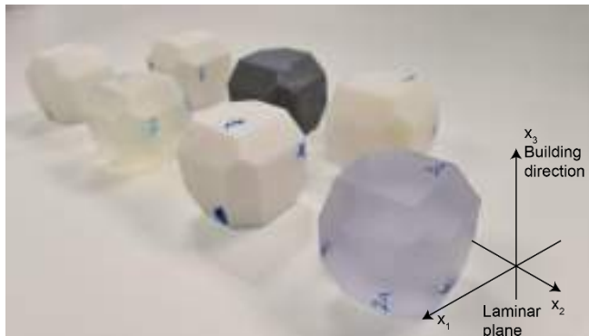
Figura 1. Ilustración de las muestras de distintos fotopolímeros impresas en 3D. Obsérvese la geometría característica utilizada en la fabricación, que permite medir la velocidad de propagación en 6 direcciones diferentes. Las tres direcciones principales x_1 y x_2 forman el plano laminar, y la dirección perpendicular, x_3 es la dirección de fabricación.
