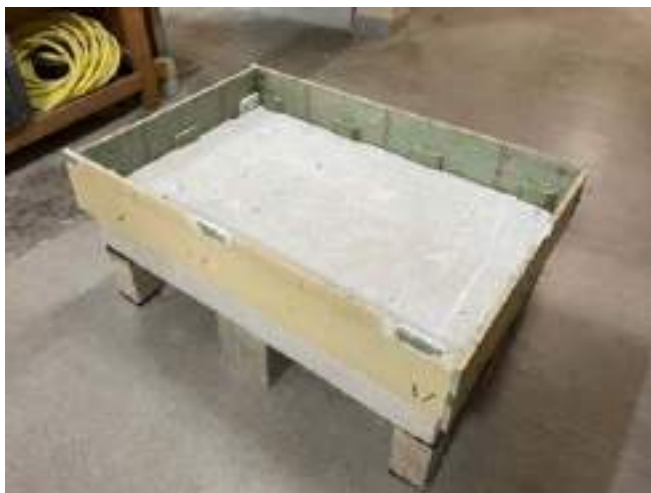
Figura 3. Encofrado para losa flotante.
