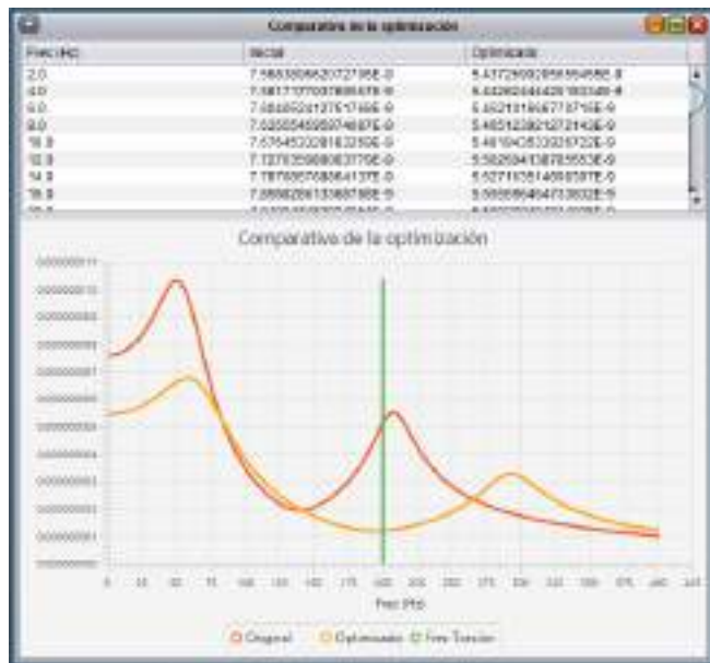
Figura 6. Optimización mediante algoritmo de la función de respuesta en frecuencia. La situación inicial (rojo) presentaba una coincidencia con la frecuencia de torsión del bogie (verde) a 200Hz. El algoritmo logra disminuir la amplitud de respuesta del raíl en la frecuencia de control (naranja), mediante la reducción de la distancia entre traviesas y de la densidad del hormigón de estas.
