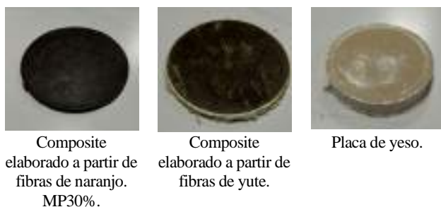
Figura 5. Muestras utilizadas en el estudio de la obtención de parámetros mecánicos a partir del método resonante.
