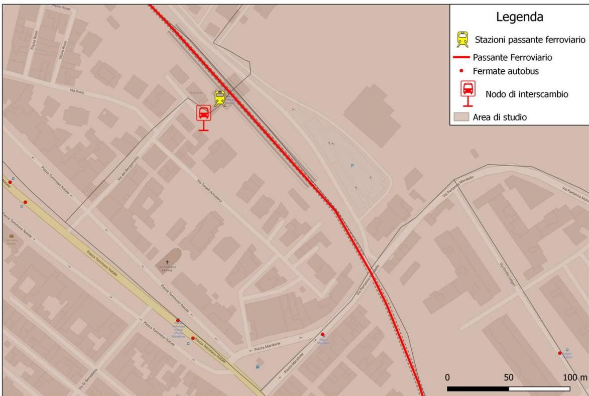
Figura 16 – Nodo di interscambio DRT-ferrovia presso la stazione “Palermo Tommaso Natale”
