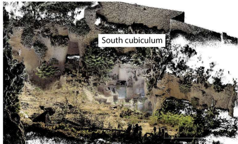
Figure 9. GeoSLAM Zeb Horizon RT point cloud of the Latomia dei Niccolini.
