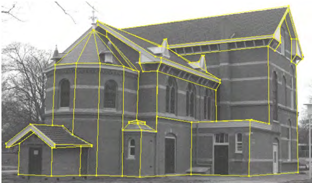
Fig. 21/ Tracciamento semi-automatico di spigoli retti sull'immagine fotografica. Van den Heuel, 1998, p. 365.
