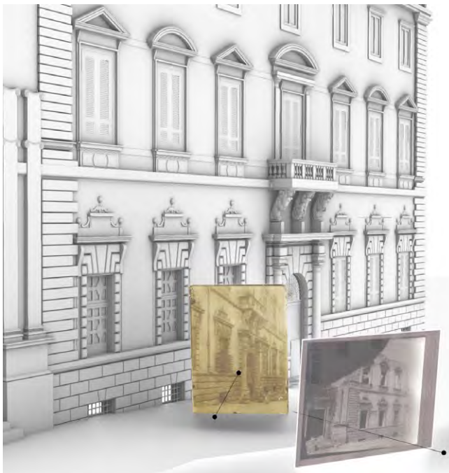
Fig. 28/ Verifica della corrispondenza proiettiva fra la prima fotografia e il modello. a) Opacità piena della fotografia. b) Opacità 50%. c) Piena trasparenza della fotografia.
