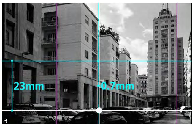
Fig. 23/ Misura del decentramento rispetto al punto baricentrico dell'immagine e confronto con la simulazione della ripresa senza decentramento. In bianco la posizione del punto principale. a) Nella fotografia, di dimensioni 6 x 9 cm, la linea d'orizzonte si trova 2,3 cm più in basso del centro geometrico dell'immagine. Si nota anche un minimo decentramento orizzontale, pari a 0,7 mm. b) L'immagini simulata differisce per l'annullamento del solo decentramento verticale; le rette verticali della fotografia sono pertanto allineate con quelle della vista del modello.
