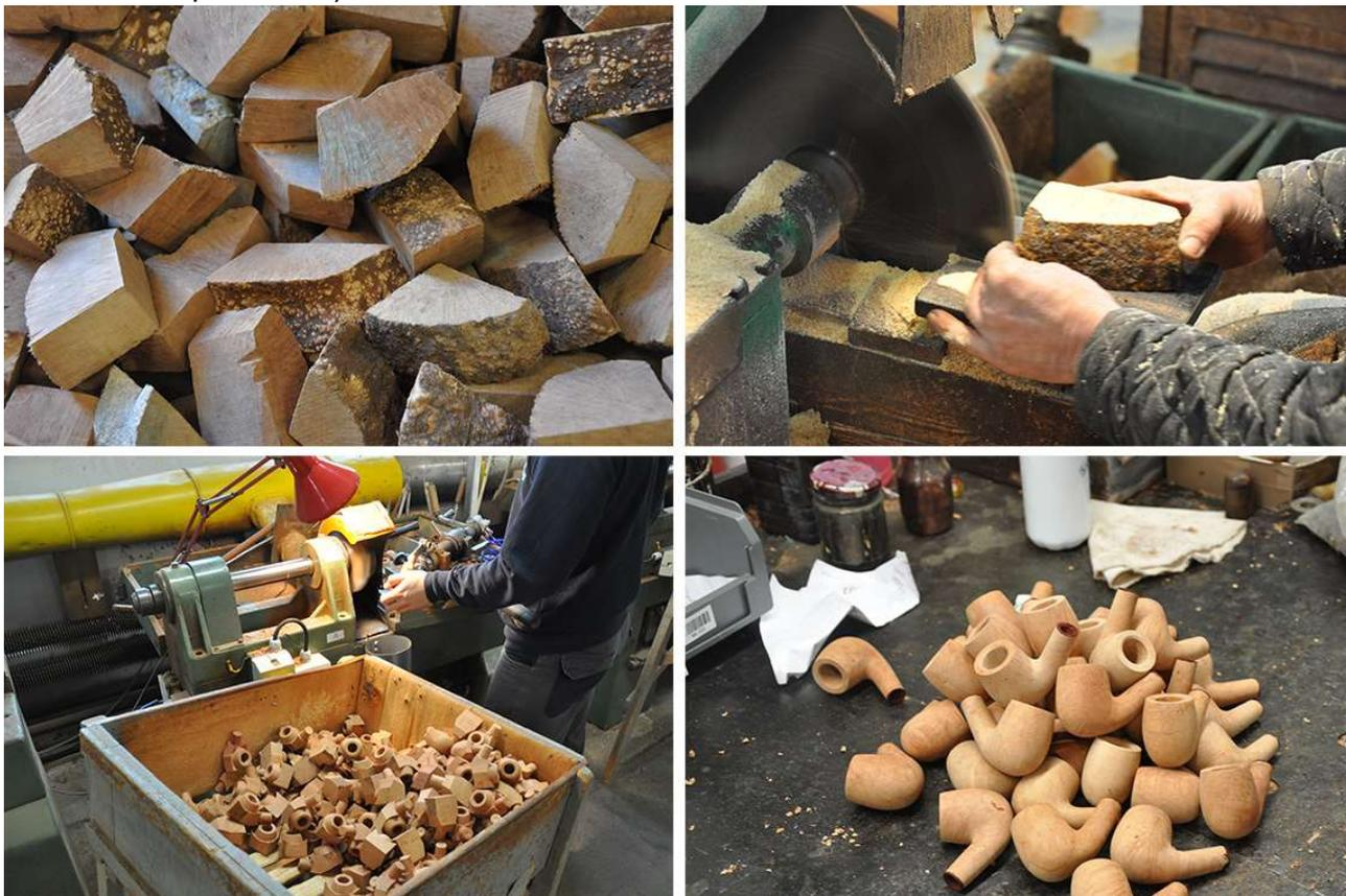
**Lavorazione del ciocco d'erica per la produzione di pipe (per gentile concessione delle ditte Manno e Savinelli)**
