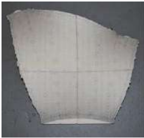
Figura IV.11. Reticolo tracciato sul modello in gesso del guscio (Chilton, 2012).
