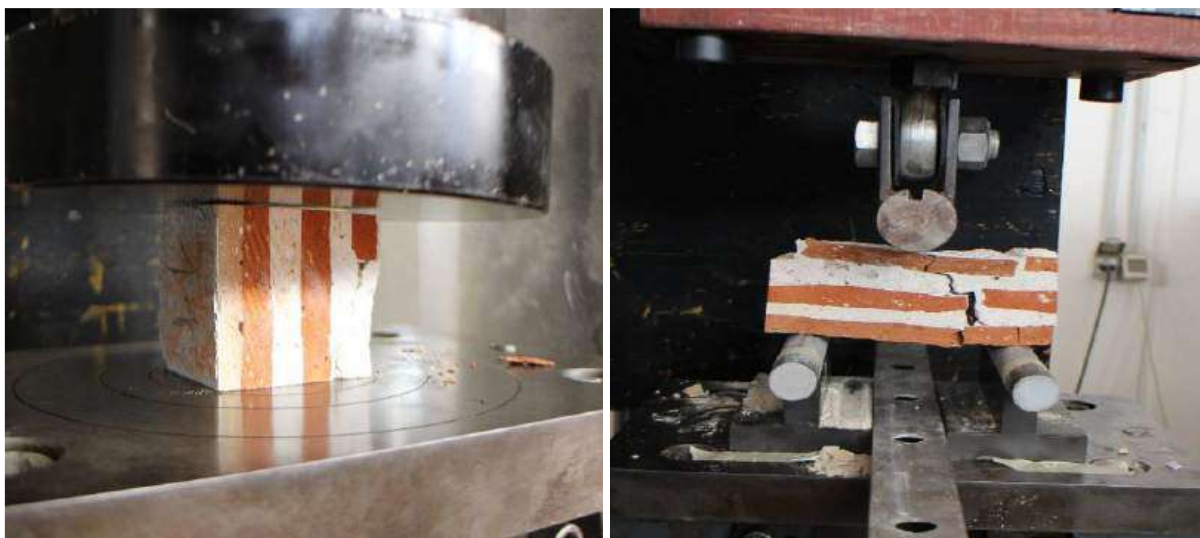
Figura III.18. Prova di compressione (a sinistra) e di trazione (a destra) di due dei provini analizzati (foto di C. Vinci).
