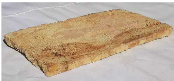
Figura III.1. Parmarizzo dello spessore di 0,8 cm rinvenuto a Partinico (foto dell'Autore).
