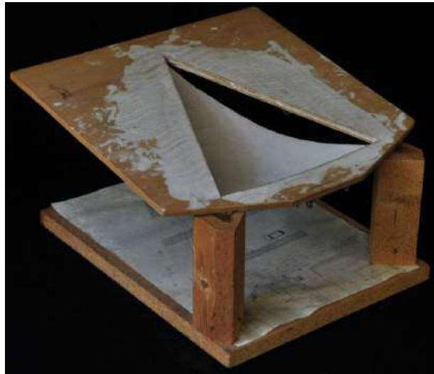
Figura IV.27. Stampo per la determinazione del modello (gta Archiv/archivio Isler rif. 217_M_7_10_415_3).
