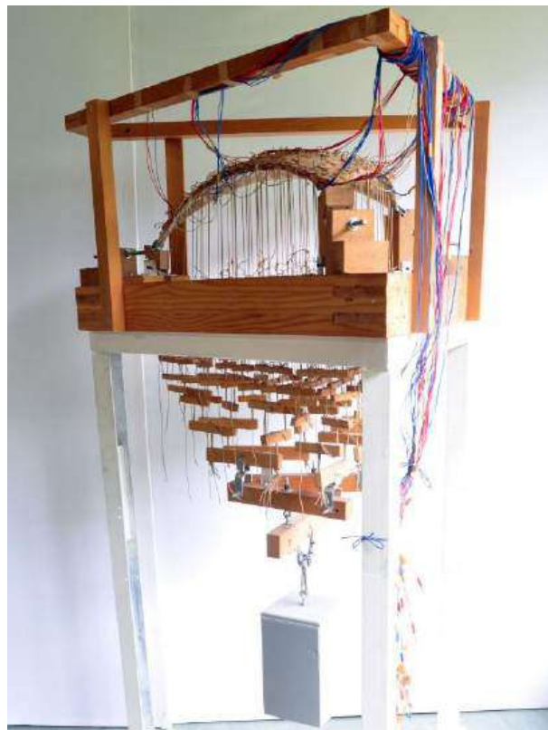
Figura IV.31. Modello di misura per l'analisi statica del guscio (gta Archiv/archivio Isler rif. 217_M_7_6_451_6).
