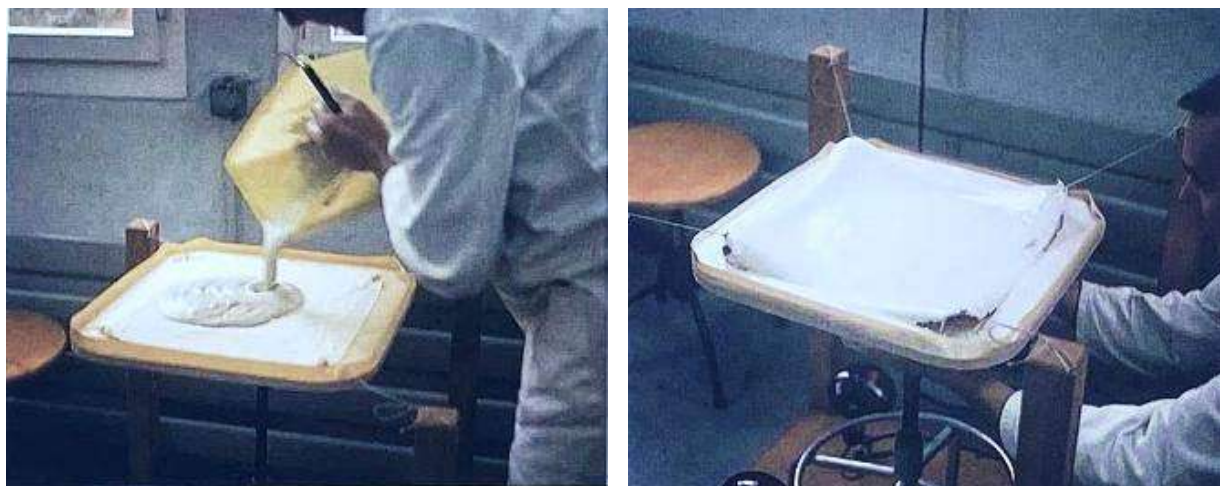
Figura IV.6. Fasi di formazione del modello hängeform (Chilton & Isler, 2000).
