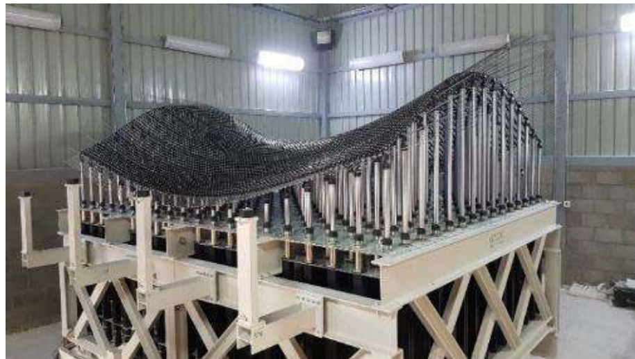
Figura II.68. adapa adaptive mould con il sistema di pistoni a cui è sovrapposta la membrana composta che darà la forma al guscio ( https://www.adapa-moulds.com ).
