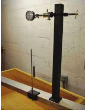
Figura IV.10. Dima utilizzata per le misurazioni dei modelli di guscio (Chilton, 2012).
