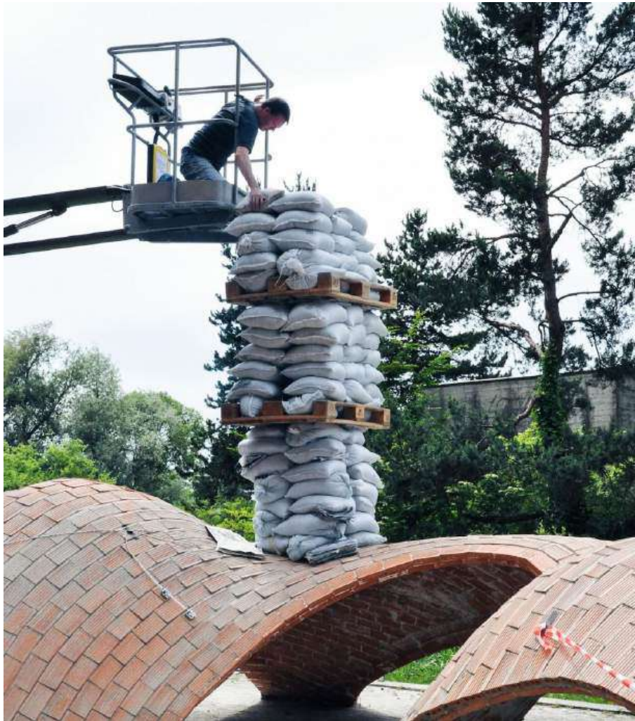
Figura II.62. Prova di carico del prototipo realizzato dal BRG a Zurigo ( https://ma-scsd.arch.ethz.ch/curriculum.html ).
