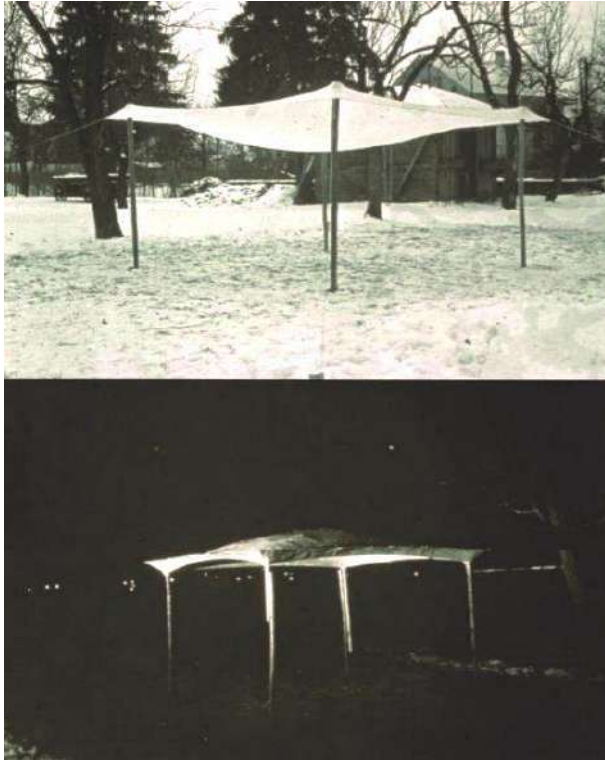
Figura IV.7. Esempio di membrana, lasciata congelare all'aperto, sospesa e invertita (Chilton, 2012).
