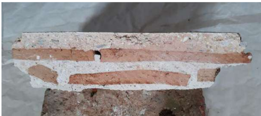
Figura III.4. Maceria di volta realina tagliata in laboratorio, proveniente da Partinico, in cui si vede la perfetta aderenza tra laterizio e gesso.
