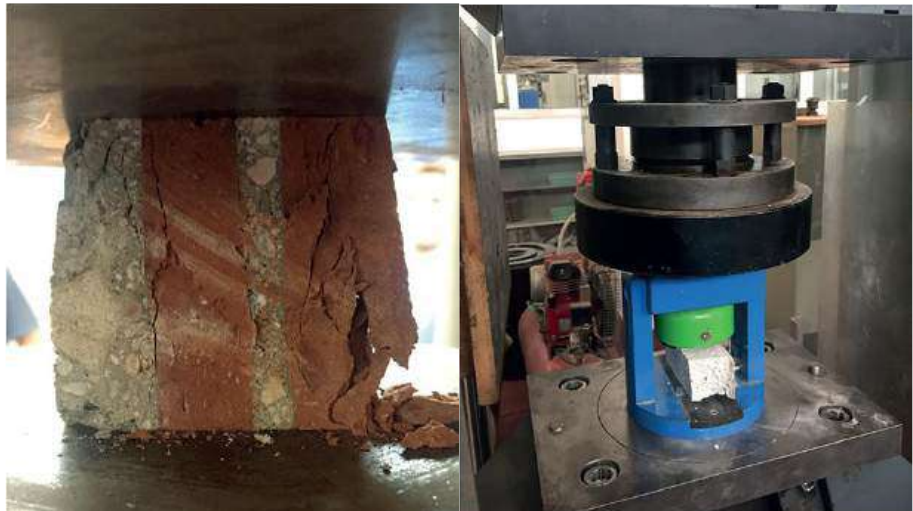
Figura III.20. Prova di compressione della muratura (a sinistra) e di trazione della malta (a destra) di due dei provini analizzati (Vallone et al., 2017).
