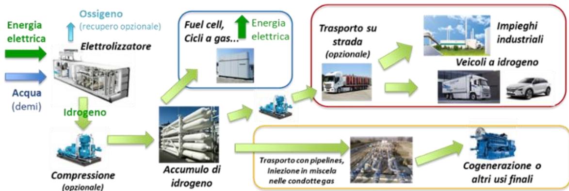
Figura 9. Sistema Power to Hydrogen e possibili usi [27]
