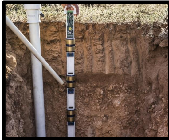
Figura 2. Esempio di sonda capacitativa di livello utilizzata per il monitoraggio del SWC. L'immagine non si riferisce al presente studio (fonte: sentektechnologies.com).
