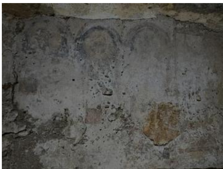
Fig. 3.44 Affresco “Teoria dei Santi” a distanza di un anno dall'applicazione dei trattamenti consolidanti. Il tassello centrale, trattato con idrossido di bario, evidenzia le migliori prestazioni in termini di stabilità cromatica e assenza di patina salina superficiale rispetto agli altri tasselli trattati con nanocalce e nanosilice.
