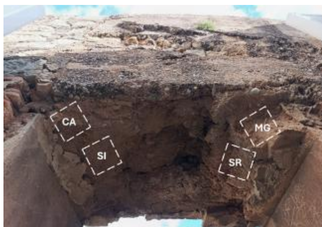
Fig. 4.18 Finestra in mattoni crudi del Castello di Sagunto (Valencia, Spagna) su cui sono stati applicati i sistemi consolidanti. I quadrati tratteggiati indicano le aree di test trattate: CA = nanocalce; SI = nanosilice; MG = nanoparticelle di Mg(OH)_2 ; SR = nanoparticelle di Sr(OH)_2 .
