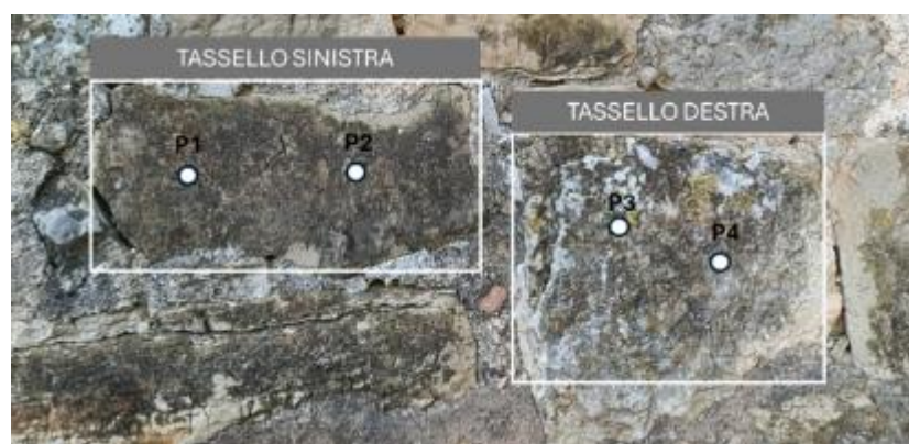
Fig. 5.18 Individuazione dei punti di campionamento sui due tasselli lapidei selezionati. I punti P1–P4 indicano le aree in cui sono stati effettuati i prelievi mediante tampone sterile per le analisi microbiologiche.
