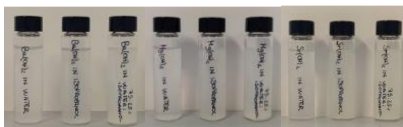
Fig 2.9. Ridispersione degli idrossidi in acqua, isopropanolo e nella miscela acqua/isopropanolo 75:25.
