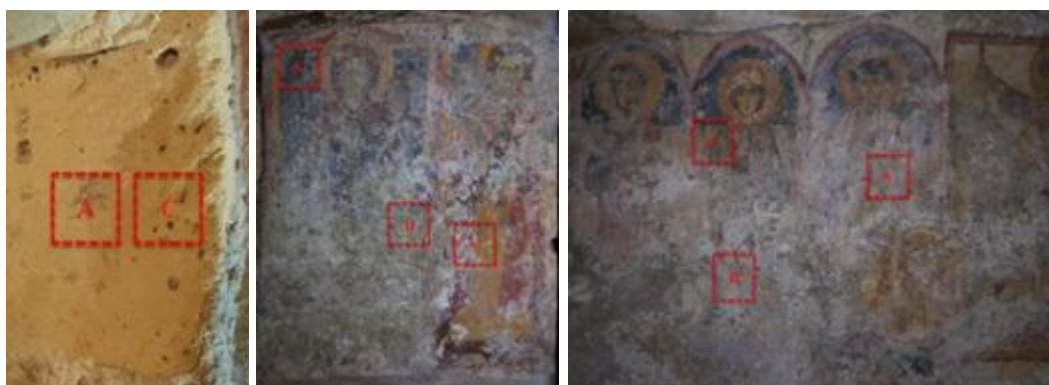
Fig. 3.35 Aree selezionate per la sperimentazione dei sistemi (A = 50% NL – 50% BH; B = 100% BH; C = 100% NL) (sinistra); modalità di applicazione dei prodotti mediante aerografo (100% NL e 50% NL – 50% BH) e a pennello (100% BH) (destra).
