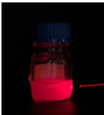
Fig. 2.2 Effetto Tyndall osservato nella dispersione di \text{Sr}(\text{OH})_2 sotto illuminazione con laser rosso. La freccia indica il percorso del fascio laser attraverso la dispersione.
