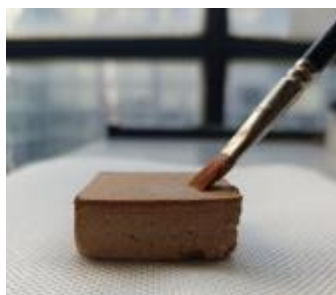
Fig. 4.5 Applicazione dei sistemi consolidanti a pennello.
