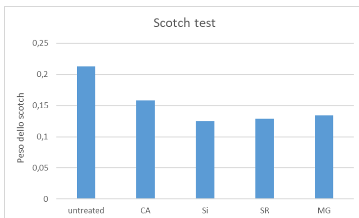
Fig. 4.16 Risultati dello Scotch Tape test eseguito sulle aree non trattate e trattate (CA, SI, SR e MG).
