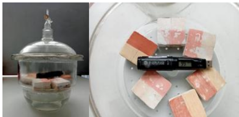
Fig. 3.21 Provini di affresco all'interno dell'essiccatore durante l'invecchiamento artificiale (sinistra); datalogger per monitorare T e UR.
