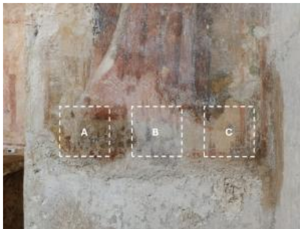
Fig.3.41 Aree selezionate per le applicazioni in situ (A: \text{Ba}(\text{OH})_2 + \text{Ca}(\text{OH})_2 ; B: \text{Ba}(\text{OH})_2 ; C: \text{Ca}(\text{OH})_2 )
