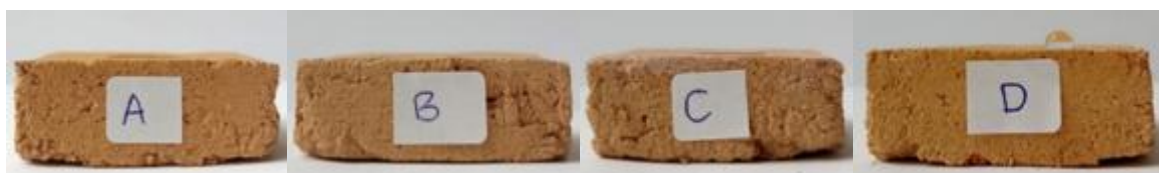
Fig. 4.6 Test di bagnabilità dei sistemi consolidanti. A= \text{Mg}(\text{OH})_2 disperso in 75% acqua e 25% isopropanolo; B= \text{Sr}(\text{OH})_2 disperso in 75% acqua e 25% isopropanolo; C=nanocalce commerciale; D=nanosilice commerciale.
