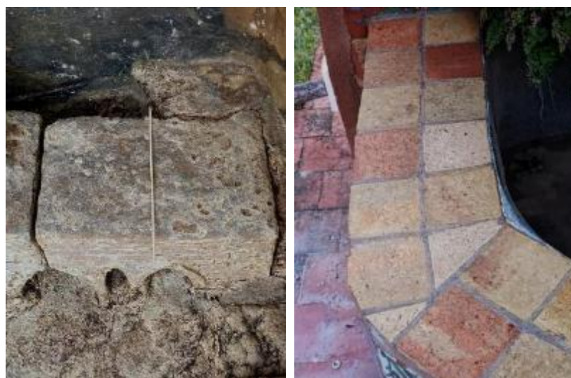
Fig. 5.16 Verifica macroscopica post-trattamento: (sinistra) porzione del gruppo scultoreo e (destra) mattonelle in cotto, entrambe caratterizzate dall'assenza di biofilm e fenomeni di ricolonizzazione.
