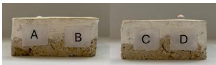
Fig. 3.24 Test di bagnabilità dei sistemi consolidanti. A = \text{Ba}(\text{OH})_2 in 75% acqua, 25% isopropanolo; B = \text{Ba}(\text{OH})_2 in 75% isopropanolo, 25% acqua; C = nanocalce; D = nanosilice.
