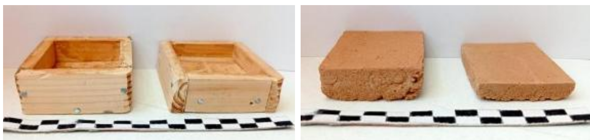
Fig. 4.4 Casseforme in legno e provini di mattone crudo ottenuti.
