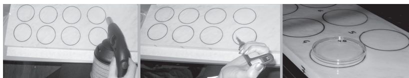
Figura 3 - Fasi di lavorazione (sterilizzazione, semina, prelievo) per la valutazione della sopravvivenza dei germi su materiali differenti (in questo caso su marmo)
