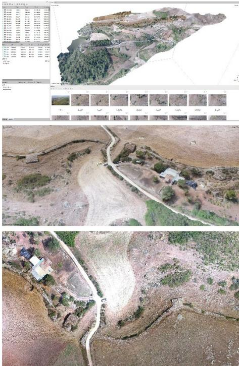
Fig. 6- In alto: Rilievo fotogrammetrico dell'area. Al centro: Mesh texturizzata calcolata con processi fotogrammetrici. In basso: dettaglio dell'ortofoto con proiezione nadirale.
