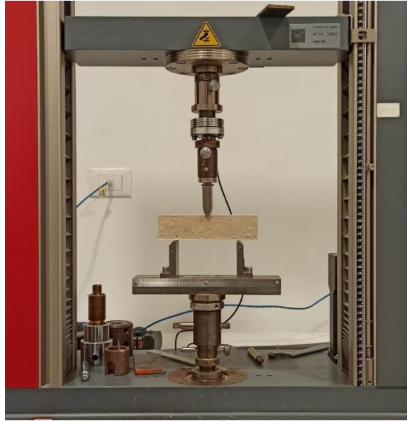
Figura 81: Esecuzione della prova a flessione
