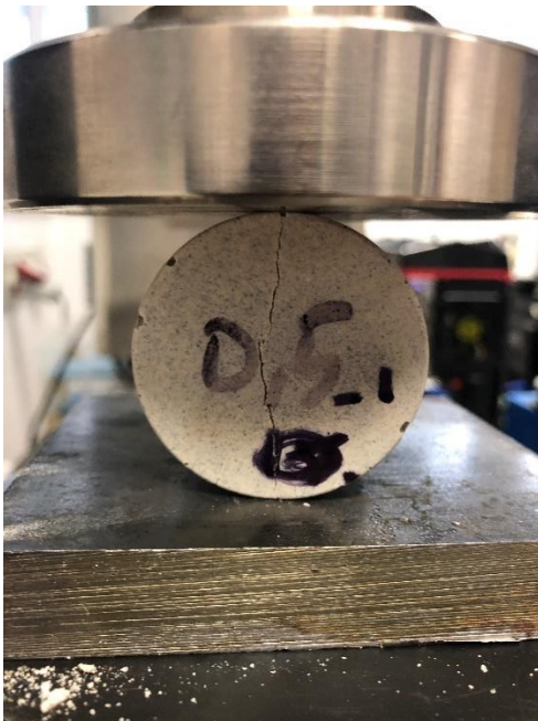
Figura 96: Esecuzione prova di trazione indiretta
