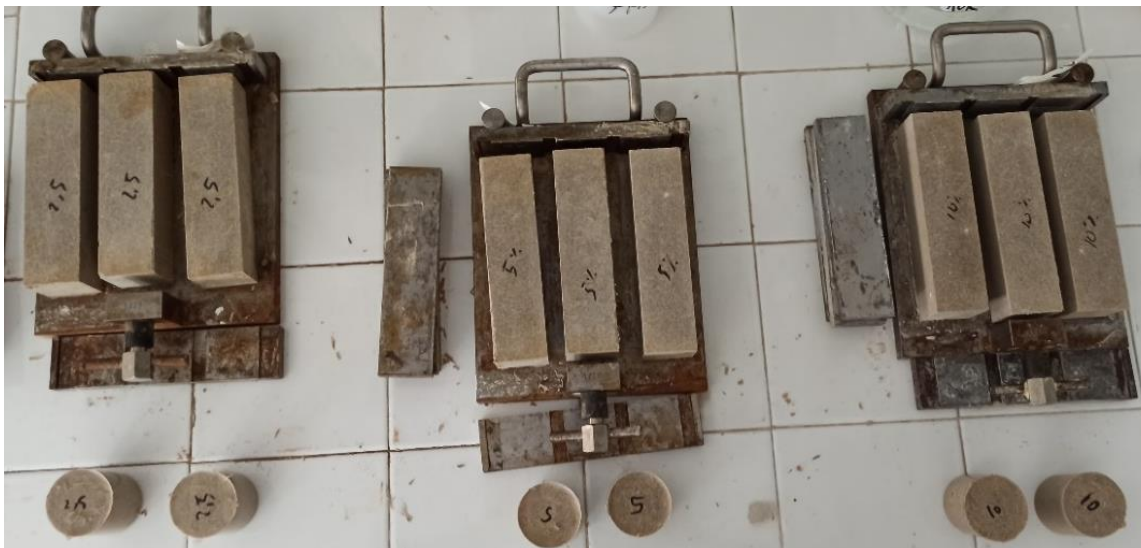
Figure 80: Sformatura dei provini
