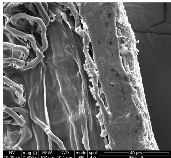
Figura 124: Microscopia elettronica a scansione per fibra trattata al 5%
