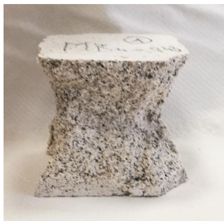
Figura 31: Rottura del campione cubico a "clessidra"
