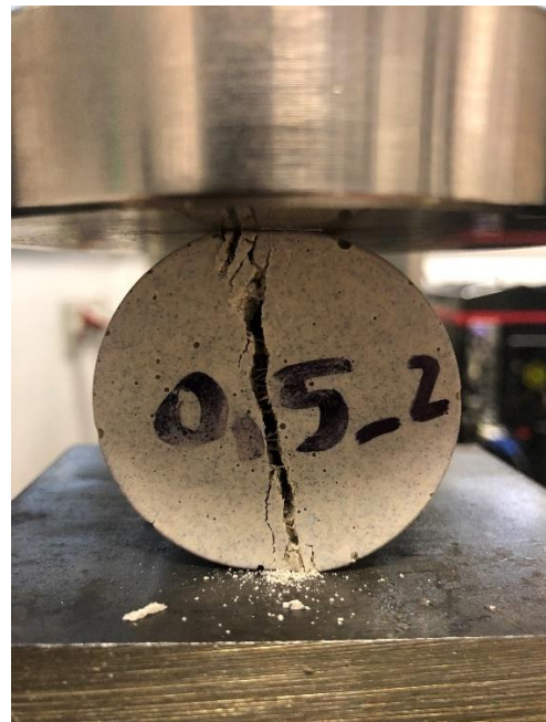
Figura 96: Esecuzione prova di trazione indiretta
