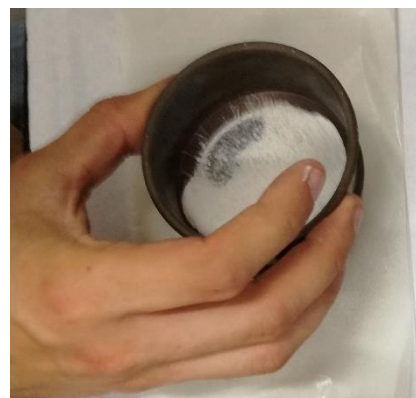
Figura 68: Preparazioni polveri per analisi XRD
