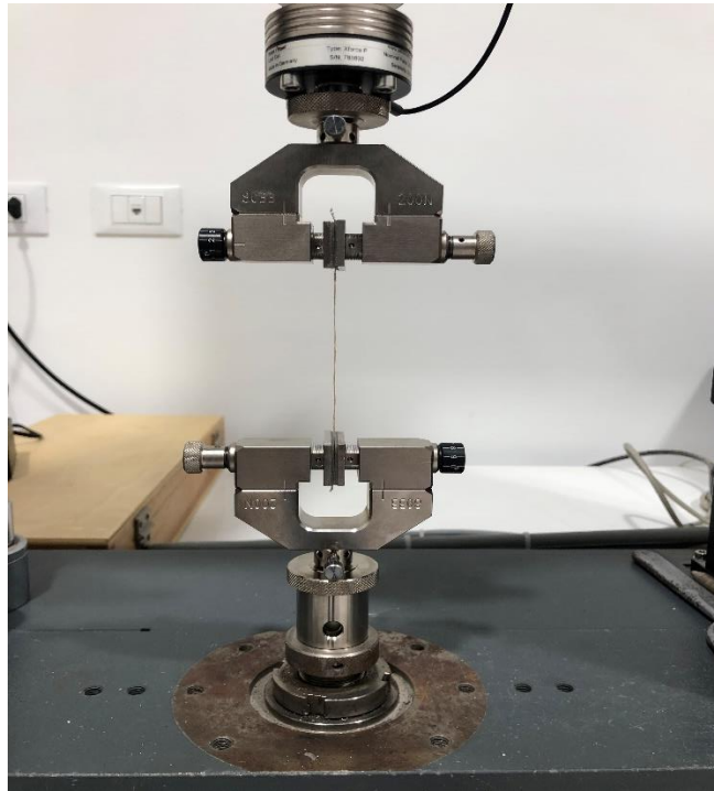
Figura 73: Setup di prova di trazione
