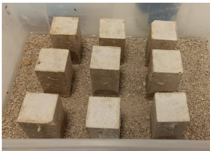
Figura 120: Esecuzione prova di assorbimento
