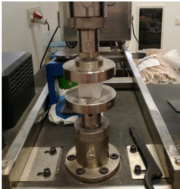
Figura 30: Prova di compressione su provini cubici
