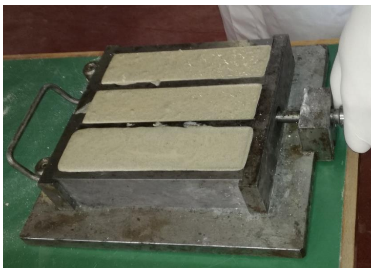
Figura 28: Vibratura dell'impasto nello stampo
