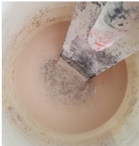
Figura 17: Realizzazione dei provini MK19_0,43_m, in foto sono visibili le due fasi separate
