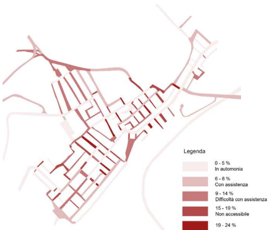
Fig. 11 - Analisi delle pendenze stradali e dell'accessibilità. (Immagine elaborata dall'Arch. Valentina Amato.)
