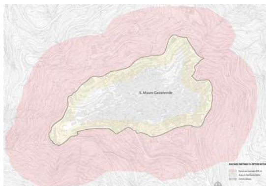
Fig. 4 - Rischio incendi di interfaccia. In rosso la fascia perimetrale di 500 m, in giallo l'area di interfaccia di 50 m in prossimità del centro abitato. (Immagine elaborata dall'Arch. Antonio Arangio.)
