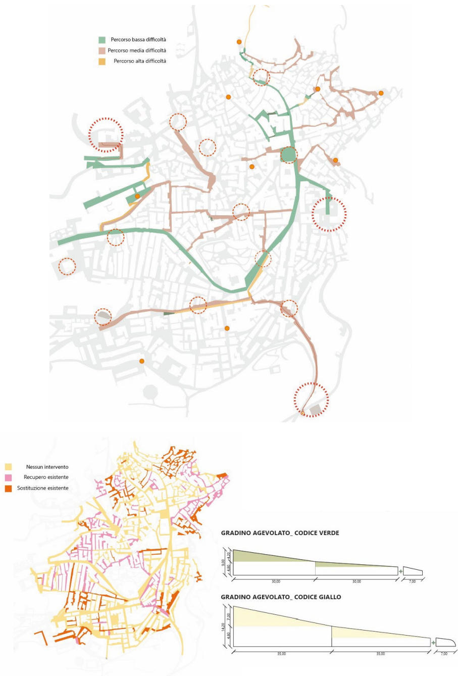
Fig. 8 - Schema dei percorsi del PEBA, degli interventi sulle pavimentazioni e del gradino agevolato. (Immagine elaborata dall'Arch. Valentina Lodato.)
