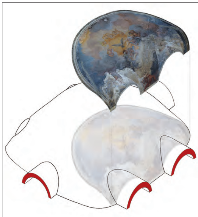
Fig. 2. Rappresentazione assonometrica dell'affresco raffigurante lo "Spirito Santo" decentrato rispetto l'asse della calotta di copertura (elaborati grafici a cura di S. Morena).
