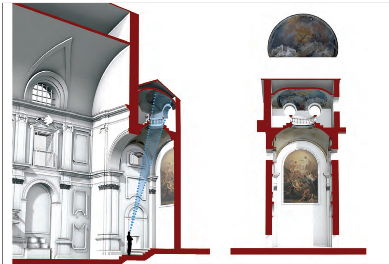
Fig. 4. A sinistra: studio del cono ottico per la vista dell'affresco raffigurante lo "Spirito Santo". A destra: sezione trasversale della doppia calotta presbiteriale della Badia Nuova di Palermo (elaborati grafici a cura di L. Barrale).
