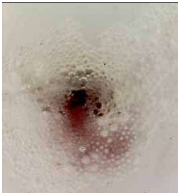
Fig. 35 – Sezione stratigrafica del campione SCQ11 sottoposto ad un test microchimico per verificare la presenza del legante oleoso: l'esito positivo dell'analisi ha confermato l'utilizzo dell'olio come medium della pellicola pittorica.
