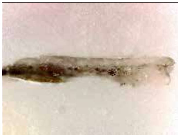
Fig. 9 – Sezione stratigrafica del campione SCQ08 sottoposto ad uno spot test finalizzato alla ricerca delle sostanze saponificabili; la formazione di un'effervescenza persistente attesta l'esito positivo della prova e quindi la presenza di un' imprimatura oleosa.
