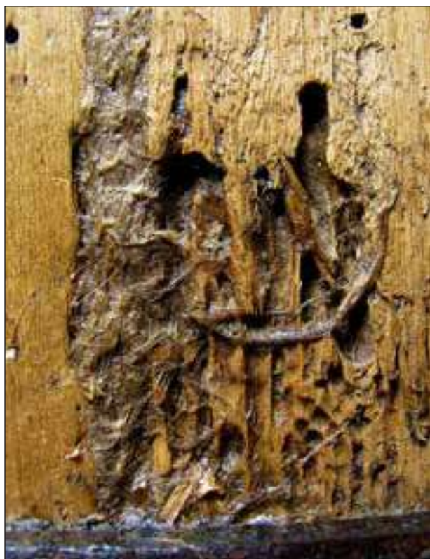
Fig. 60 – Cristoforo Faffeo (attr.), Santa Barbara , ultimo quarto del XV secolo, Museo Diocesano di Palermo, particolare della reintegrazione plastica del legno mediante impasto a base di canapa e colla organica relativa al restauro di Pizzillo del 1884.
