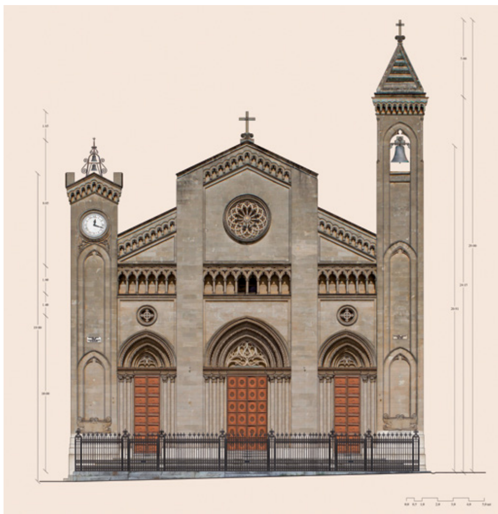
Fig. 5 - Raddrizzamento del prospetto principale, Bagheria, chiesa S. Sepolcro (arch. M.P. Papia, 2023).
