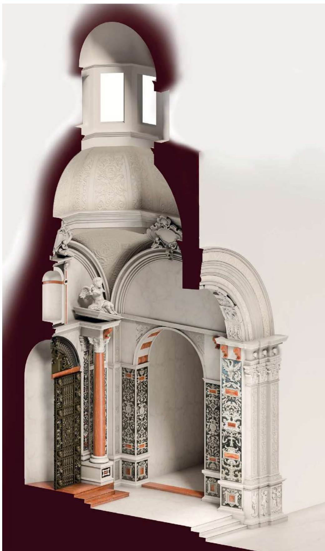
Fig. 10. Spaccato assonometrico del modello digitale della cappella di santa Rosalia (elaborazione degli autori).
