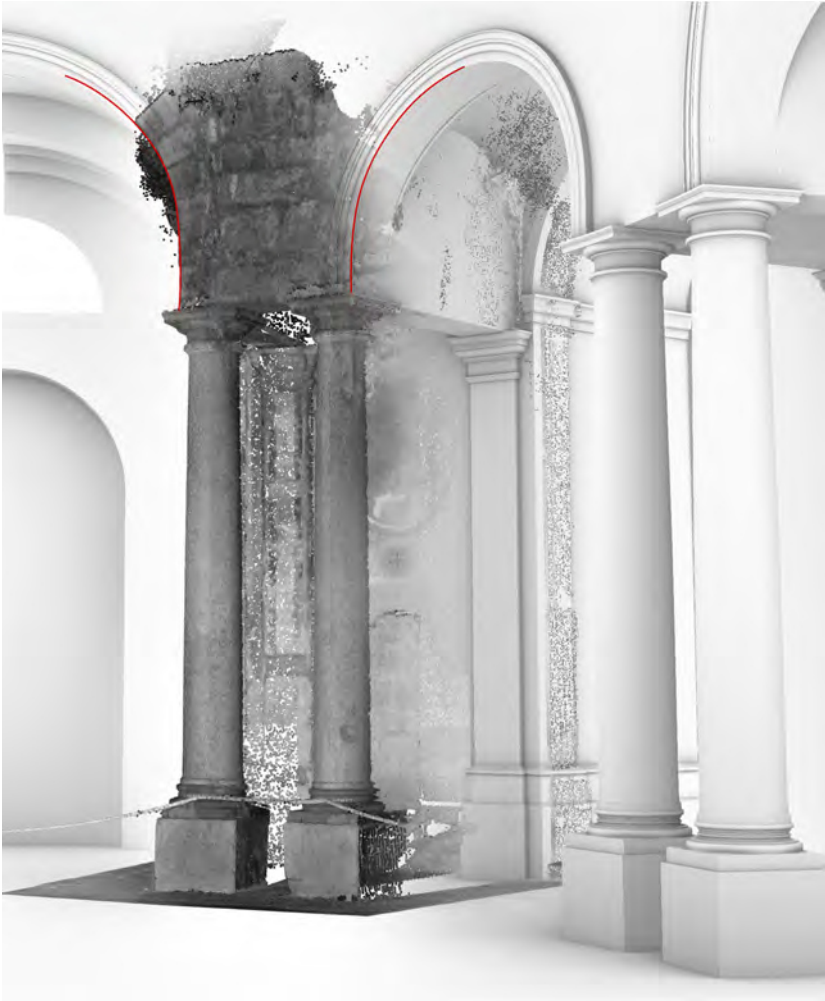
Fig. 5. Analisi della nuvola di punti, definizione delle geometrie delle circonferenze e ricostruzione virtuale degli archi delle serliane della chiesa di Sant'Ignazio a Mazara (elaborazione grafica di Mirco Cannella).
