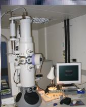
Caratterizzazione morfologica al SEM e rilassometria FFC-NMR del biochar per la definizione della porosità e della mobilità funzionale dell'acqua nei pori.
