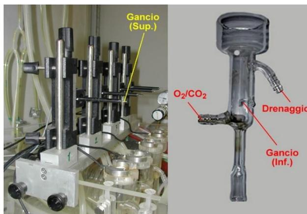
**Figura 33** a) Trasduttori di forza, ove è possibile notare il gancio superiore (Gancio Sup.); b) Primo piano di un canale in cui si osserva il gancio inferiore (Gancio Inf.) e gli sbocchi per la miscela  $O_2/CO_2$  e per il drenaggio.
