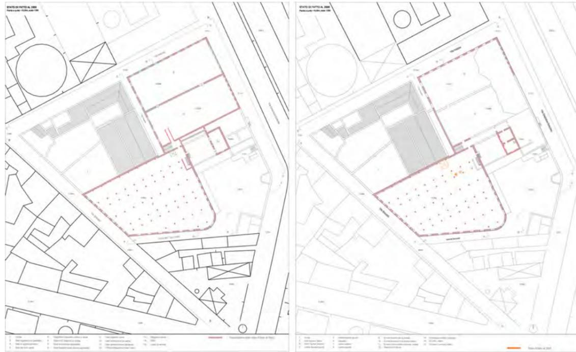
Fig. 8 - Confronto tra il ridisegno dello stato di fatto al 1955 e il rilievo del complesso realizzato nel 2008. Planimetrie a quota +16.00m.
