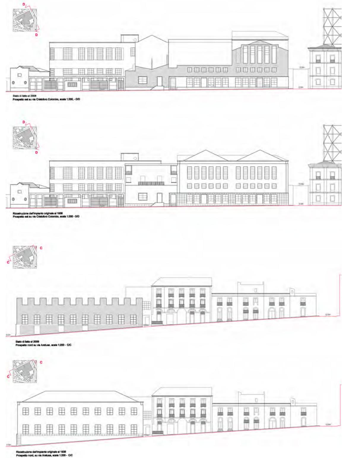
Fig. 10 - Prospetti. Confronto tra il rilievo dello stato di fatto realizzato nel 2008 e la ricostruzione originaria del 1938.
