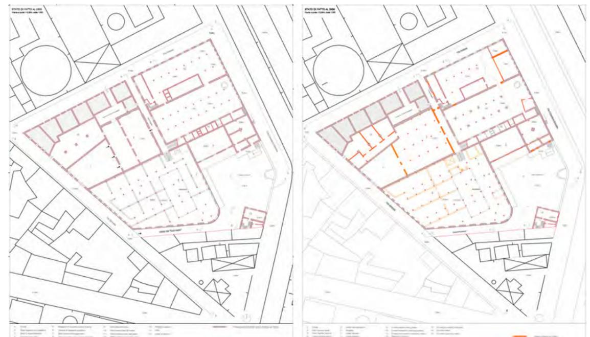
Fig. 7 - Confronto tra il ridisegno dello stato di fatto al 1955 e il rilievo del complesso realizzato nel 2008. Planimetrie a quota +12.00m.
