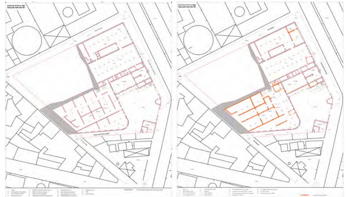
Fig. 6 - Confronto tra il ridisegno dello stato di fatto al 1955 e il rilievo del complesso realizzato nel 2008. Planimetrie a quota +9.50m.
