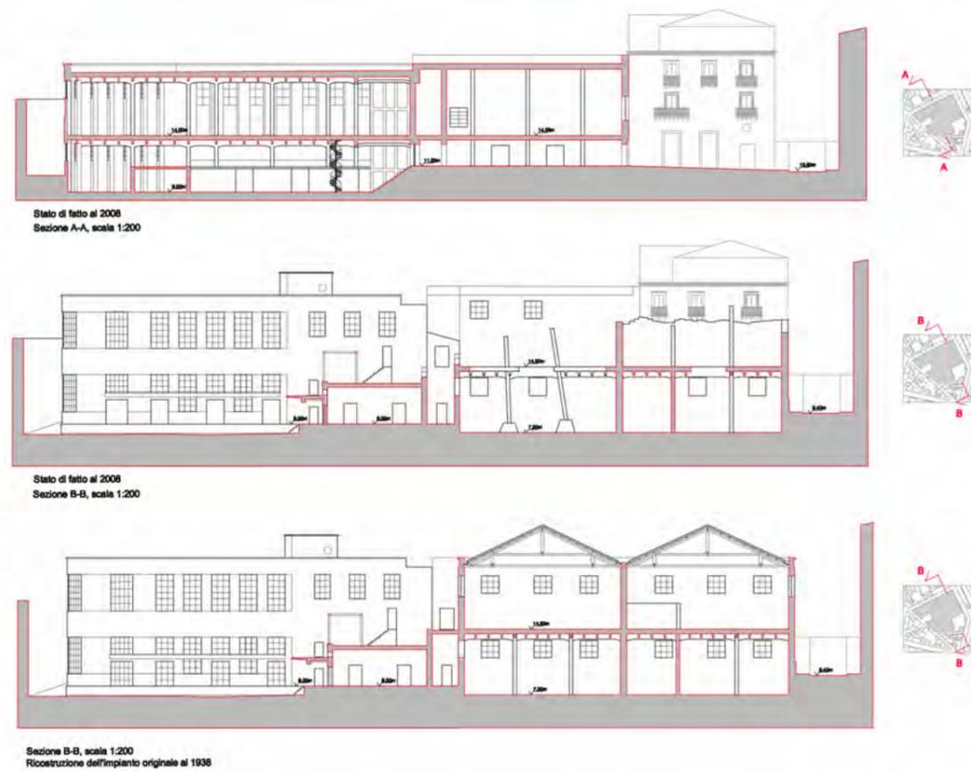
Fig. 9 - Sezioni. Confronto tra il rilievo dello stato di fatto realizzato nel 2008 e la ricostruzione originaria del 1938.
