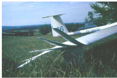
Fig 3: Estremità alare ispirata all'ala di un falco, la configurazione è stata ottimizzata mediante un algoritmo genetico (fonte: http://www.bionik.tu-berlin.de/institut/xtutor1.htm )
