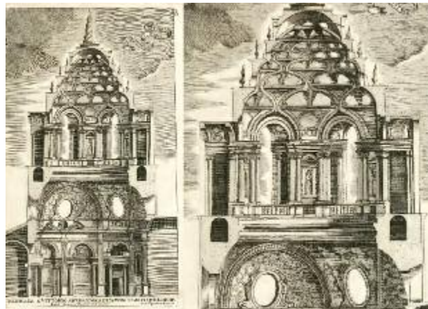
Fig. 39. G. Guarini, progetto per la cappella della SS. Sindone, sezione e dettaglio del sistema di copertura (da GUARINI, 1686, tav. 3).
