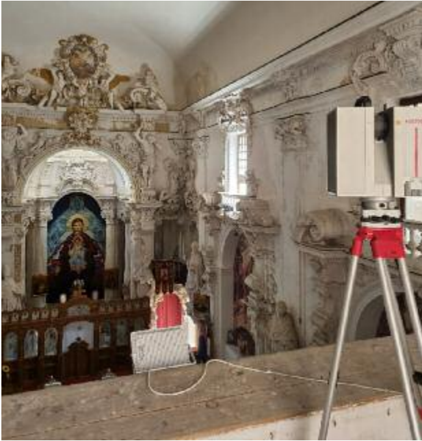
Fig. 1. Rilevo laser scanning dell'interno della chiesa dell'Immacolatella a Trapani (foto M. Cannella).
