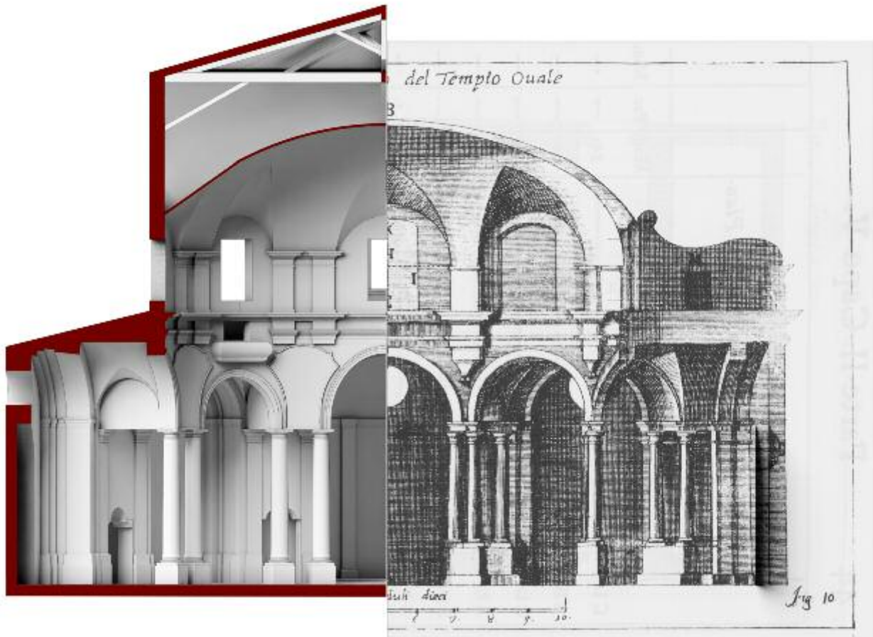
Fig. 17. Sezioni trasversali della riconfigurazione virtuale della chiesa di Sant'Ignazio a Mazara (a sinistra) e del Tempio a pianta ovale di Amico (a destra) (elaborazione grafica di M. Cannella).
