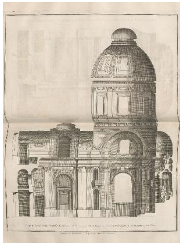
Fig. 9. J. F. Blondel, Coupe et Profil de la Chapelle du Château de Fresne pris sur sa longueur (da BLONDEL 1738).
