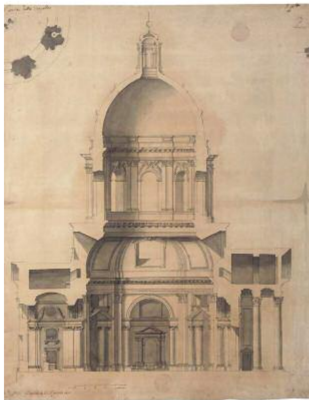
Fig. 55. C. Desgots, Progetto di chiesa a pianta ottagonale, sezione longitudinale. Terzo premio, Concorso Accademico 1677, (prima classe), (AAsI 009, da GUIDOBONI 2016, p. 54).
