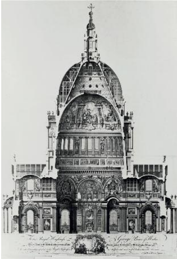
Fig. 53. S. Wale e J. Gwynn, sezione della cattedrale di St. Paul a Londra fatta per il principe di Galles, 1755 https://commons.wikimedia.org/wiki/File:Dome_cross_section.jpg
