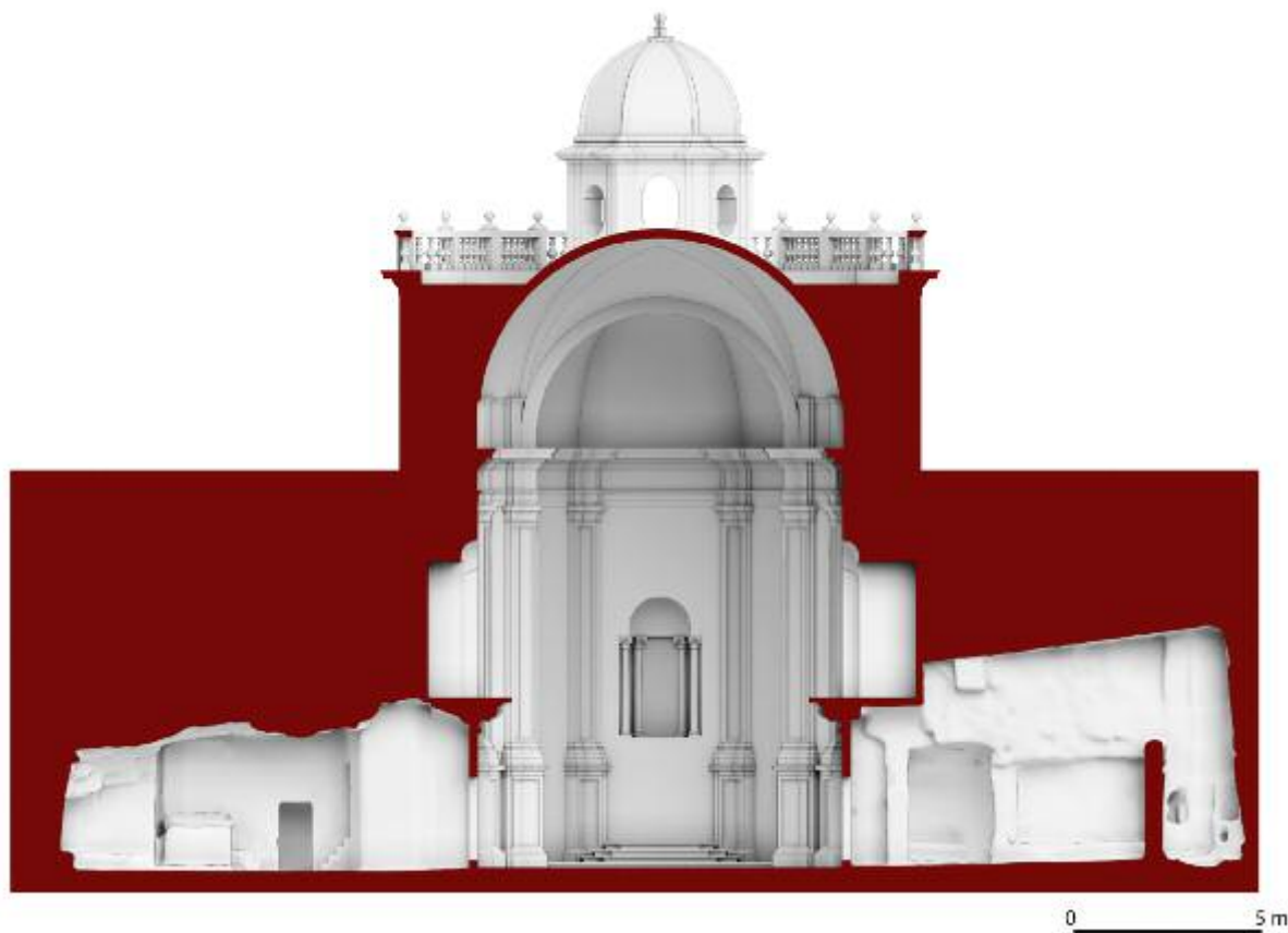
Fig. 44. Sezione trasversale della chiesa di Santa Maria della Grotta e degli ambienti ipogei situati ai lati della navata unica (elaborazione grafica di M. Cannella).
