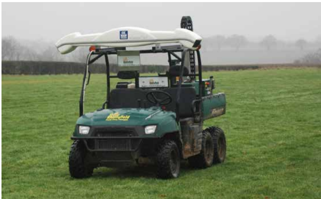
Sensore per il telerilevamento dello stato nutrizionale (N-Sensor, foto Yara).
