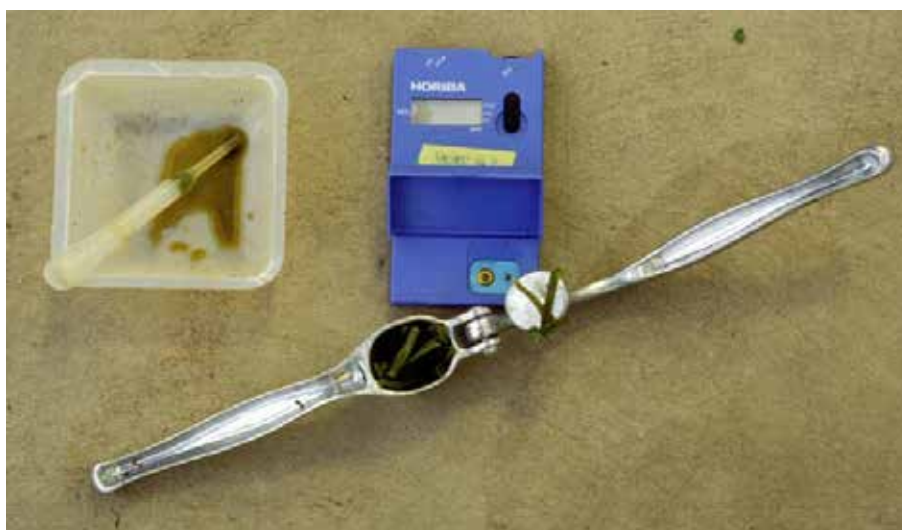
Preparazione di un campione per l'analisi del contenuto di nitrati (Horiba Ltd, UK)
