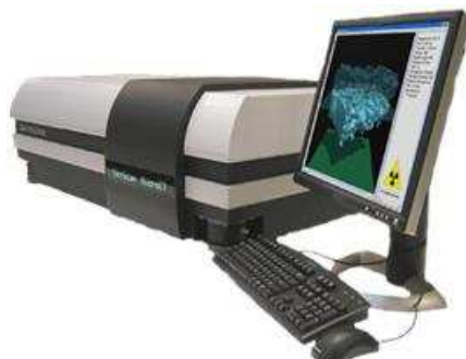
Figura 4.4.1. Micro tomografo Skyscan Mod. 1172
