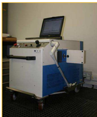
Figura 3.2.2: Apparato strumentale LIBS disponibile nel Laboratorio di Tecniche Fisiche per lo studio e la caratterizzazione dei Beni Culturali del Dipartimento di Fisica e Tecnologie Relative dell'Università di Palermo
