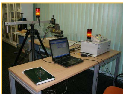
Figura 3.2.1: Apparato strumentale XRF disponibile nel Laboratorio di Tecniche Fisiche per lo studio e la caratterizzazione dei Beni Culturali del Dipartimento di Fisica e Tecnologie Relative dell'Università di Palermo
