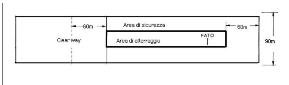
Figura 6.49: Area di sicurezza per operazioni strumentali
