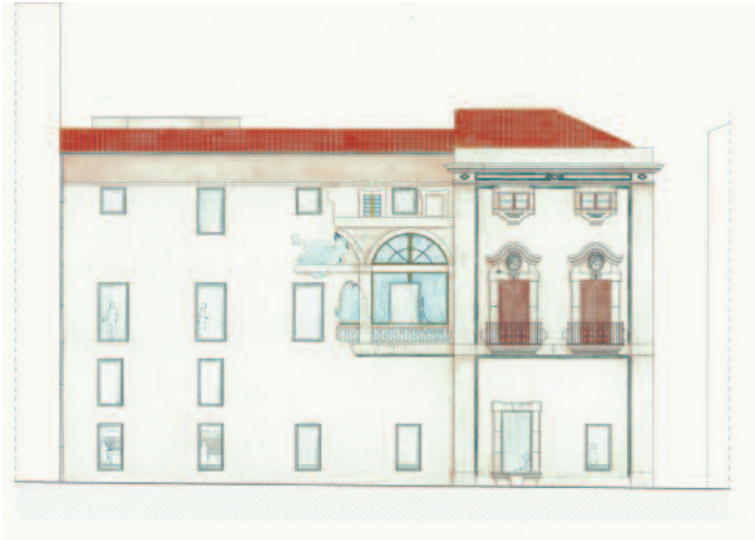
Il Palazzo Oneto in via Bandiera. Fronte su piazza Bottego: rilievo dello stato di fatto, progetto didattico di restauro, restauro effettivamente realizzato. Le poche tracce residue della finta loggia non autorizzano il ripristino effettuato, peraltro irrealizzabile nella sua forma completa, per le successive aperture e trasformazioni interne.
