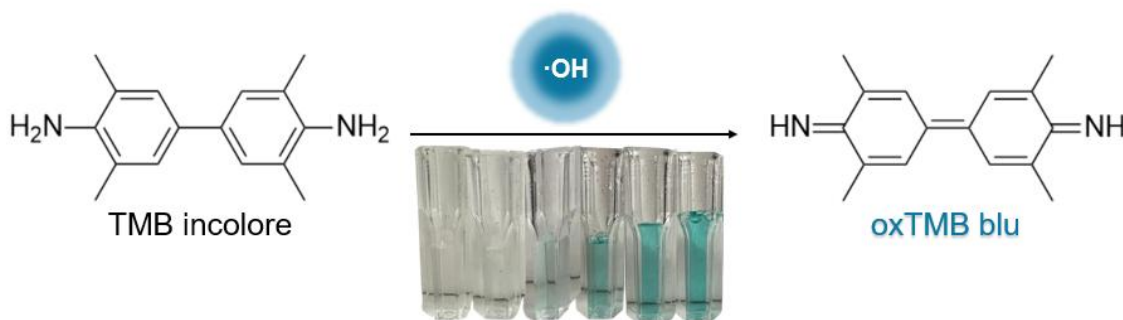
Figura 60. Illustrazione schematica del processo di ossidazione del TMB da parte di \cdot\text{OH} generato dalla reazione Fenton
