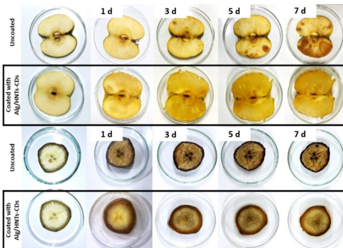
Figura 16. Fette fresche di mela e banana non rivestite e rivestite con il film nanocomposito Alg/HNTs-CDs/E dopo 7 giorni di conservazione a temperatura ambiente con umidità relativa (RH) = 60 %.
