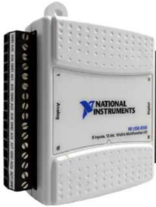
Figura 59 scheda di acquisizione NI
