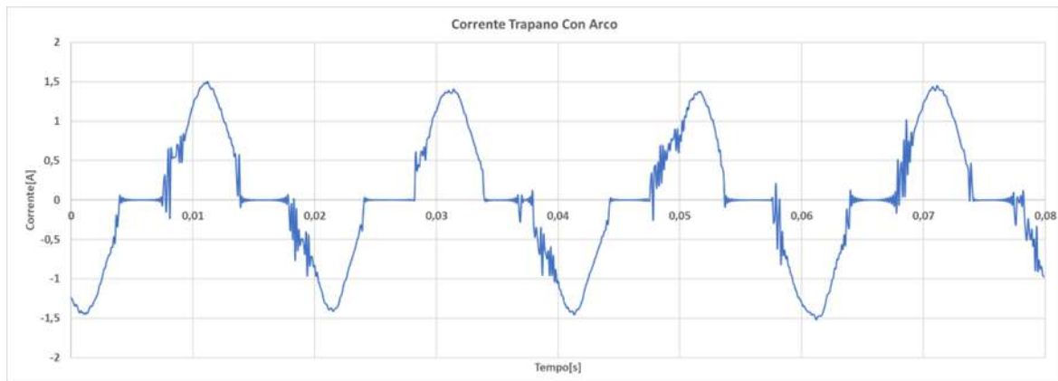
Figura 70 Forma d'onda di corrente in presenza di arco
