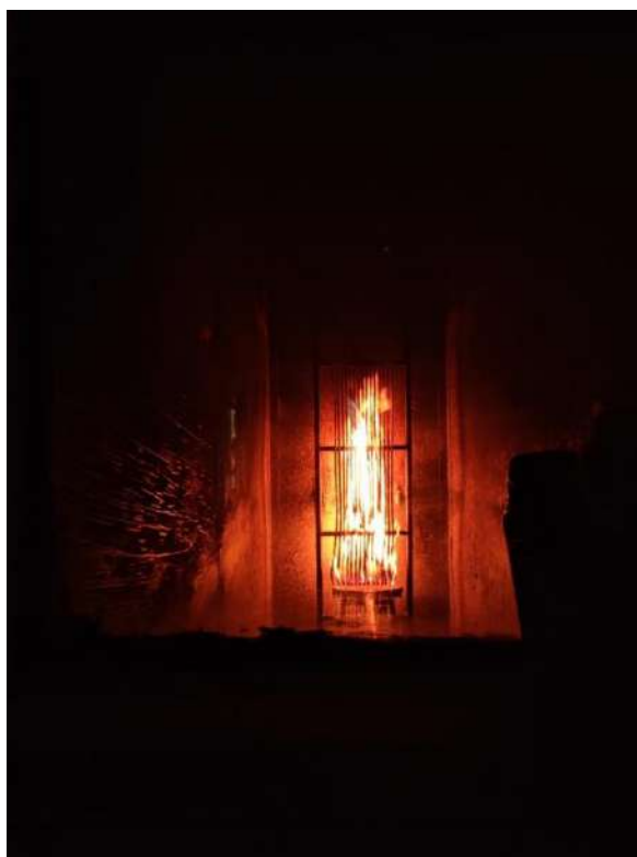
Figura 2 test reazione al fuoco cavi elettrici
