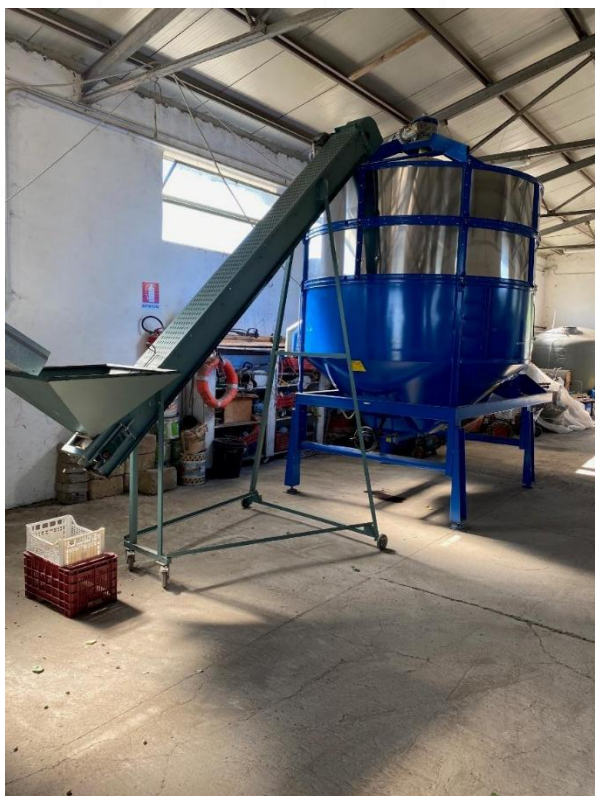
Figura 3. Secado de frutos de pistacho ( Pistacia vera L.) en un secadero mecánico, utilizado para completar la fase de secado de forma controlada y más rápida que el método solar
