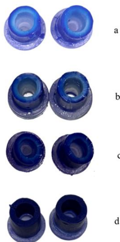
Figure 95: Diffusion Tests under Static Conditions at: a) 10 min, b) 20 min, c) 30 min, d) 40 min
