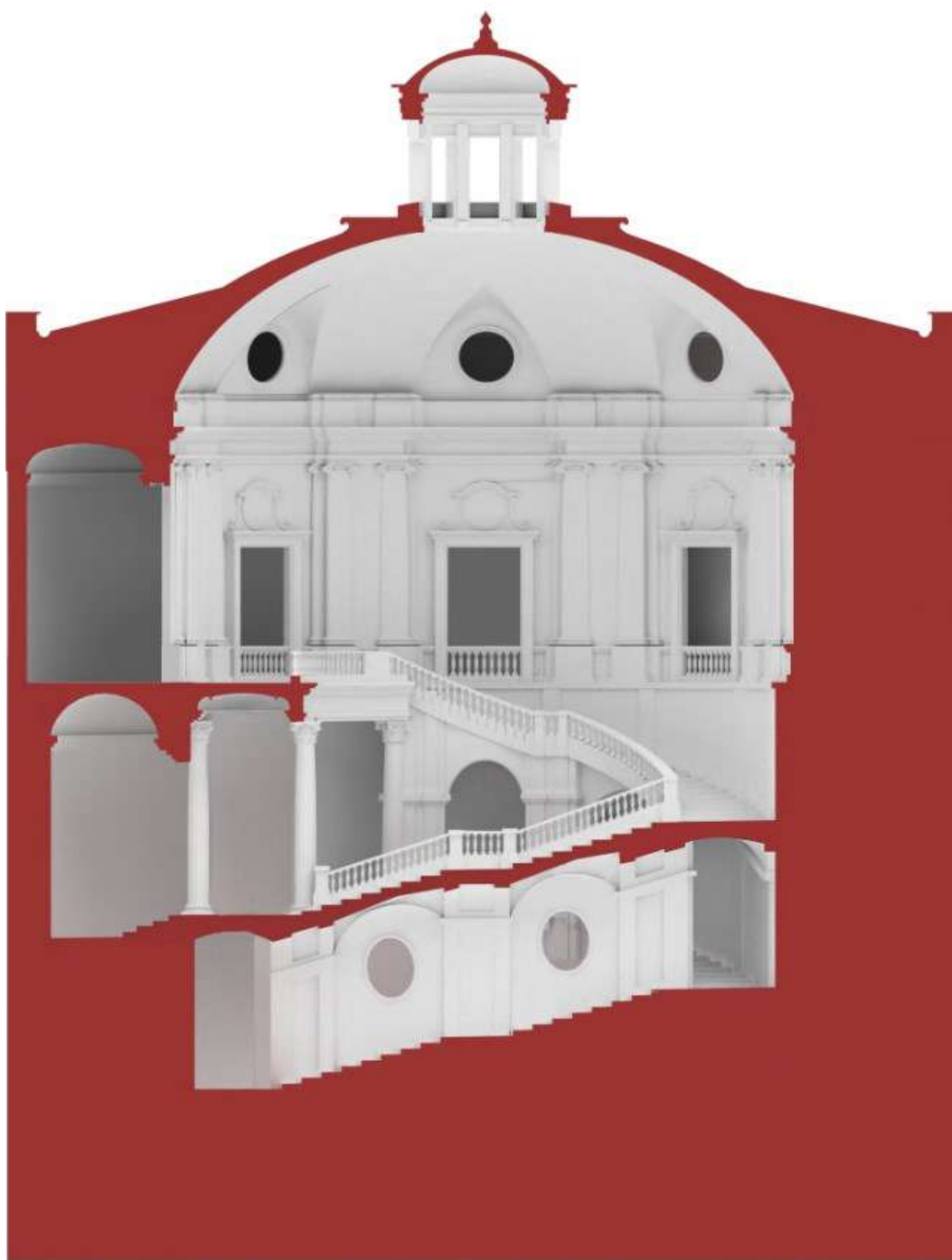
Fig. 49 Sección de la escalera del modelo digital del “ Edificio para la Academia de las Tres Nobles Artes... ”, Proyecto académico de V. Verda, primer premio de primera clase, 1756 (elaboración gráfica a cargo de C. Patuzzo)
