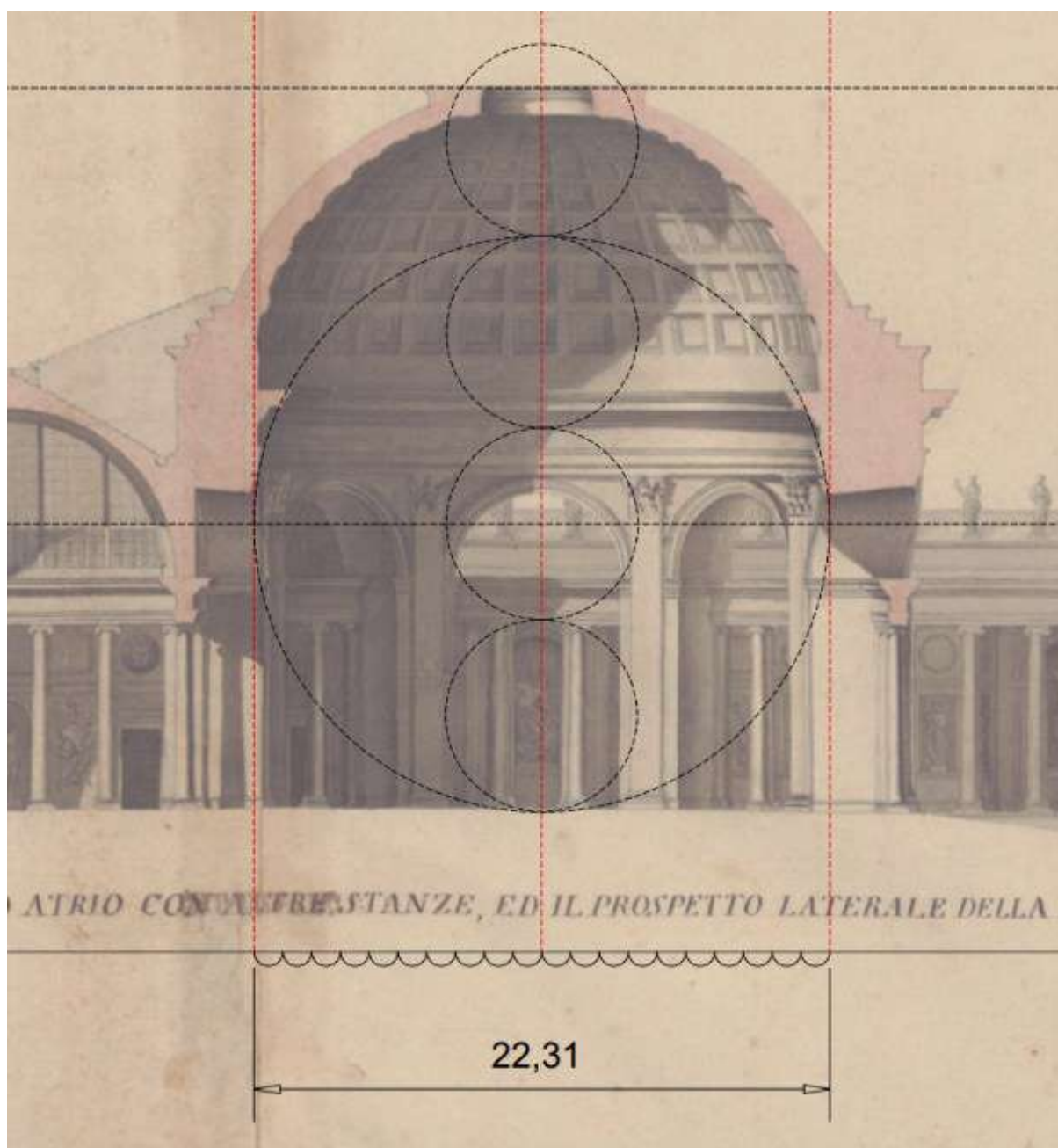
Fig. 88 G. V. Marvuglia, Concorso Clementino 1758 “Gran Piazza magnificamente ornata di Portici ...”, prima classe secondo premio, sezione longitudinale, dettaglio dell’atrio, analisi geometrica (elaborazione grafica di C. Patuzzo)
