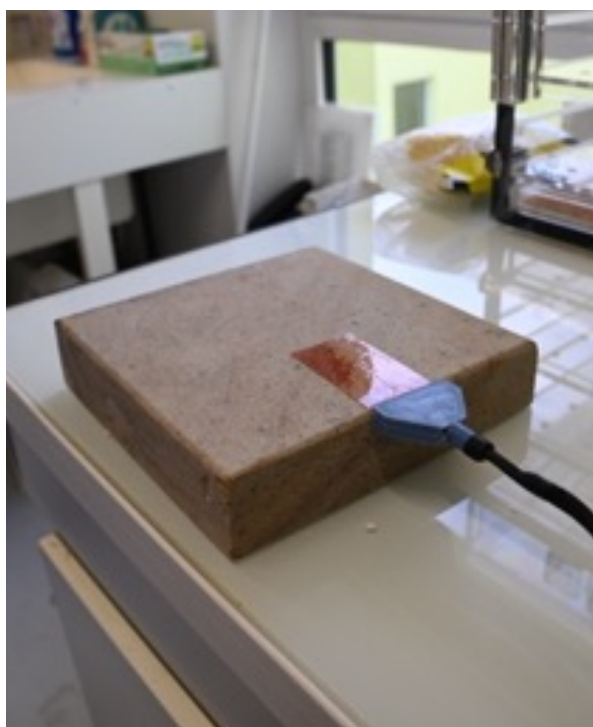
Fig. 4.12 Applicazione della sonda a filo caldo a contatto con i provini.
