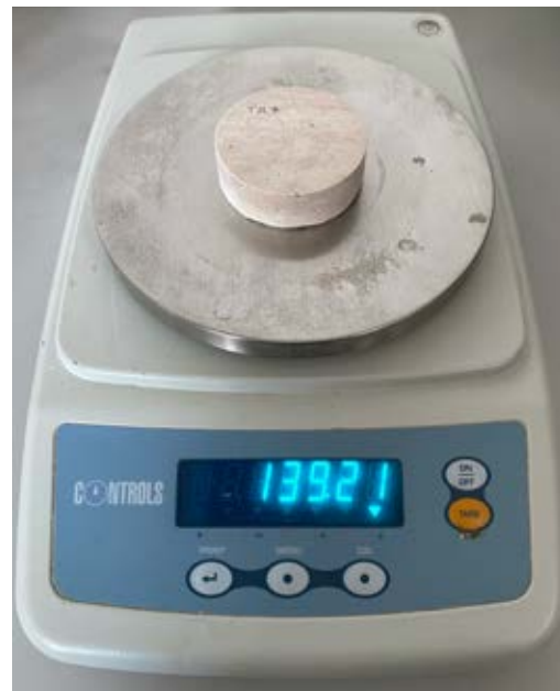
Fig.4.3 Pesatura provino di travertino pre-essiccazione.
