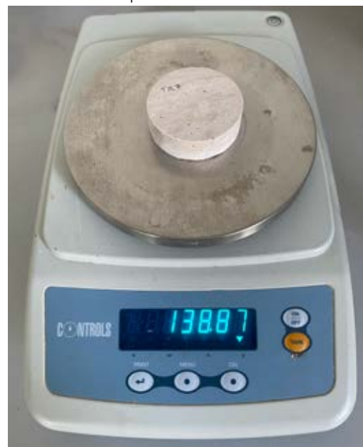
Fig. 4.5 Pesatura provino di travertino post-essiccazione.
