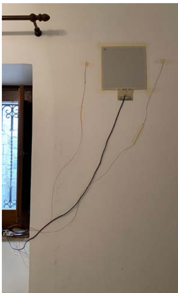
Fig. 4.31 Applicazione dei sensori all'interno del muro di tipo SM2.1 a Petralia Sottana.
