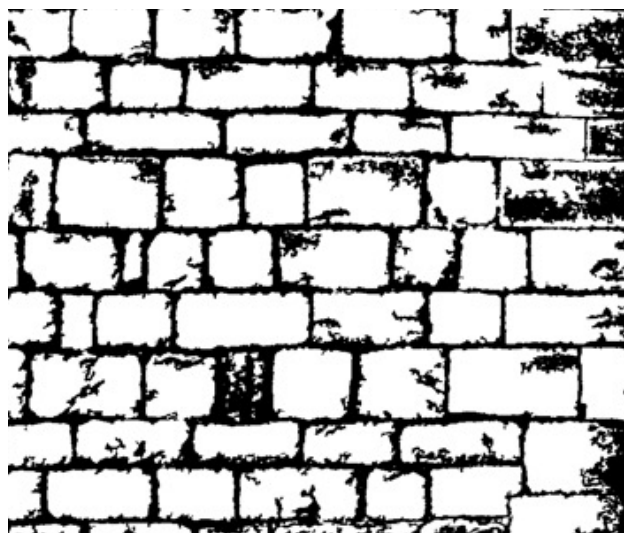
Fig. 6. 9 Immagine segmentata con " Image Segmenter " corrispondente alla muratura SM1.
