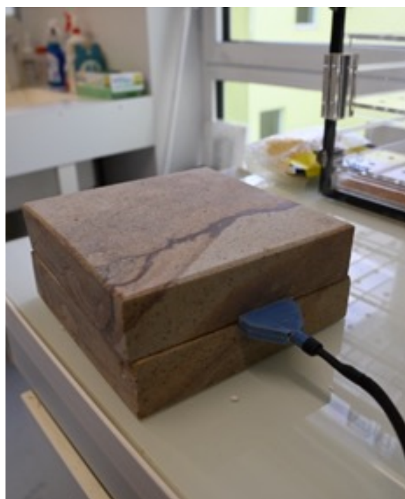
Fig. 4.13 Svolgimento della misura di conducibilità su provini di quarzarenite.
