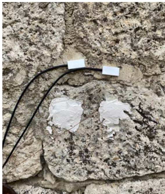
Fig. 4.26 Applicazione a parete esterna dei sensori Almemo ed Extra Tech a Bompietro.
