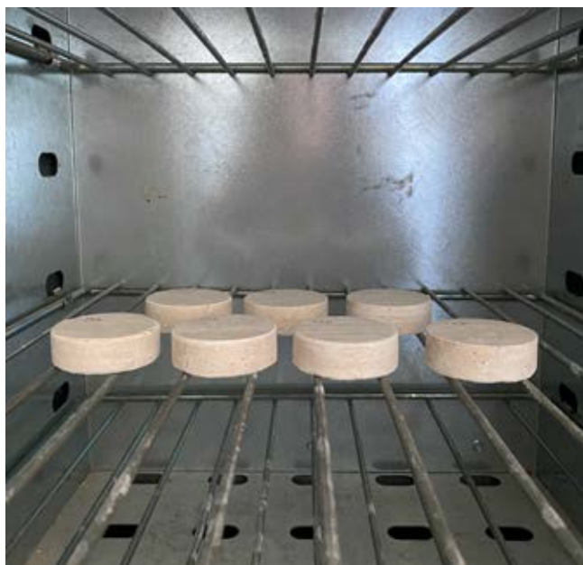
Fig. 4.4 Essiccazione dei provini di travertino in forno
