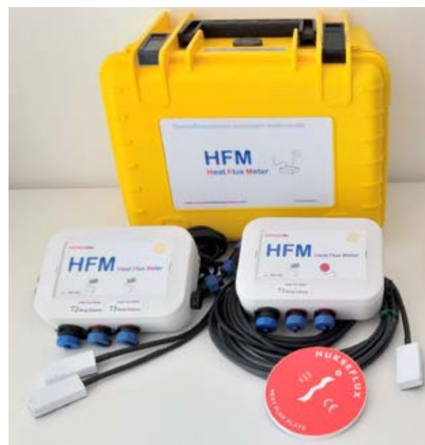
Fig. 4.17 Sistema di monitoraggio HFM Extratech
